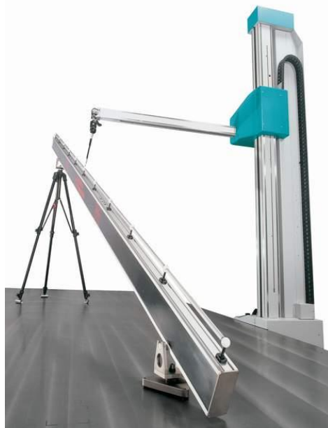
Obrázek 16: Multi ball bar (10)
