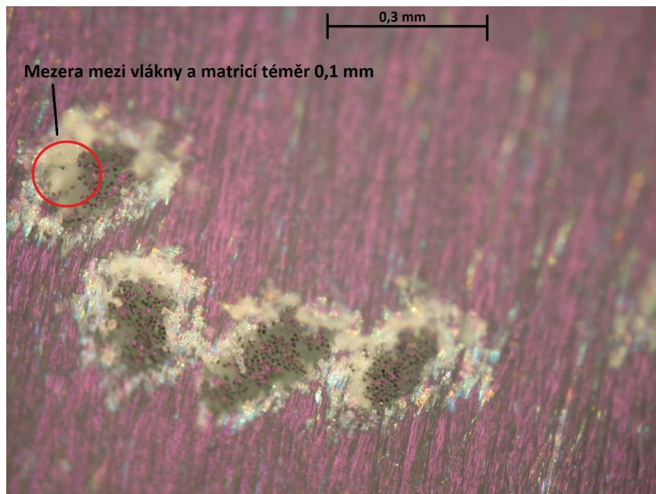
Obrázek 32 - Snímek vzorku se skleněnými vlákny, zvětšeno 10x
