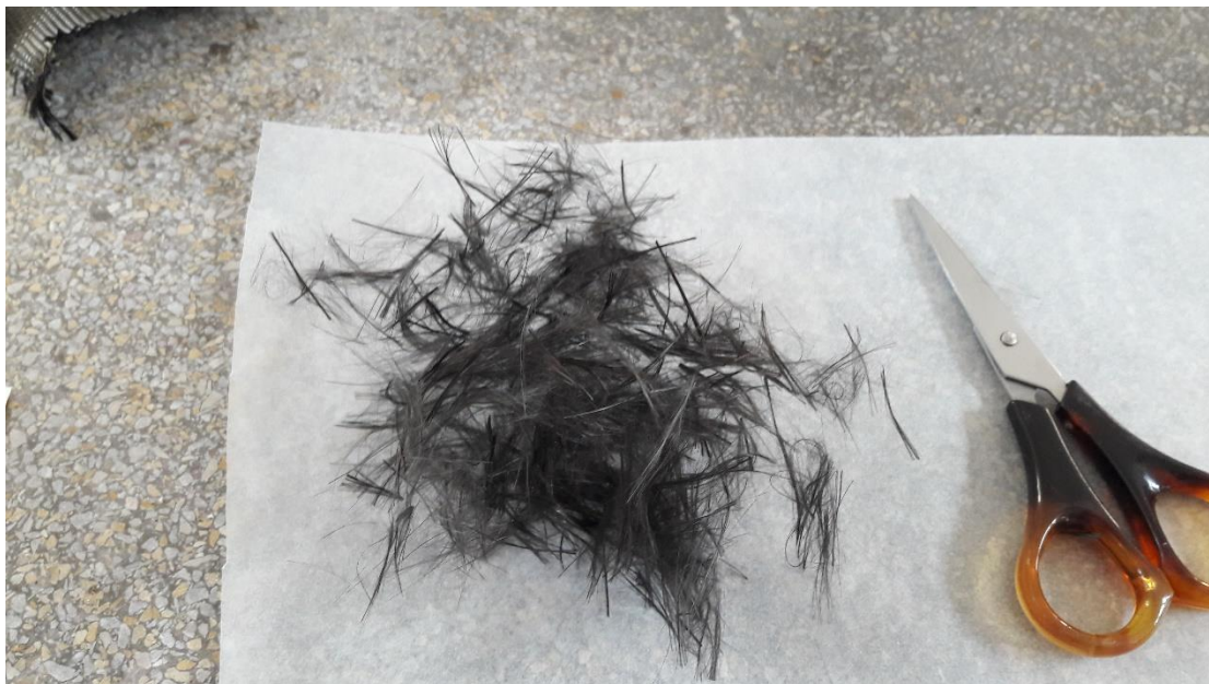
Obrázek 16 - Roztřepená a nastříhaná uhlíková vlákna, krátká
