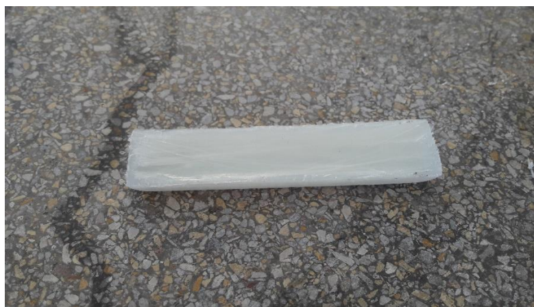
Obrázek 20 - Hotový vzorek se skleněnými vlákny
