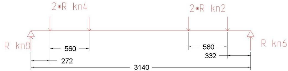
Obr. 44 Schéma sil a zatížení podélného nosníku podélného pojezdu N3
