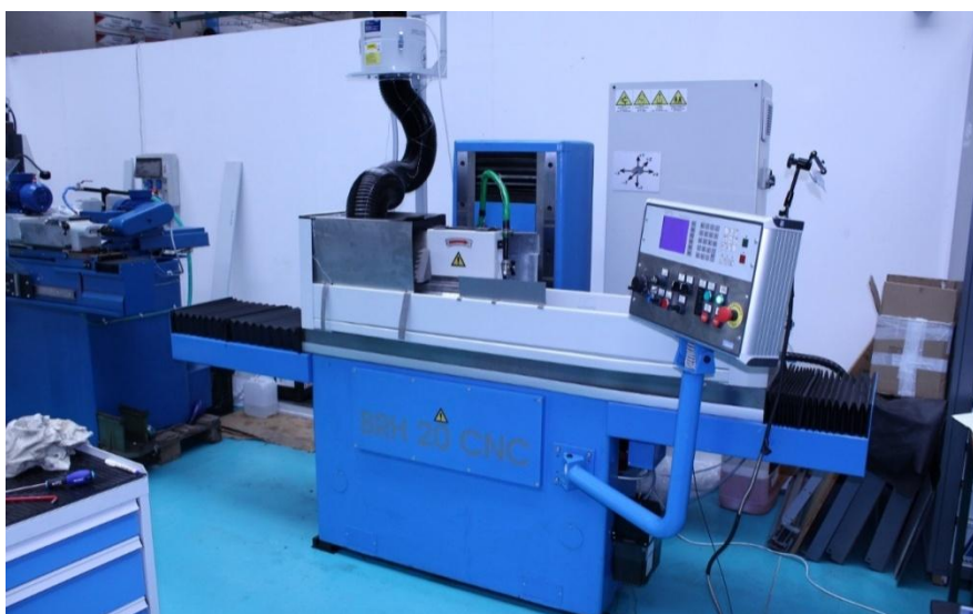
Obrázek 30 Bruska Mikronex BRH 20 CNC osazená dynamometrem a externím odlučovačem
