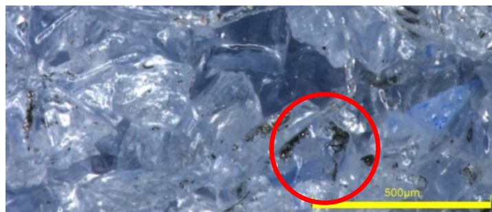
Obrázek 38 Detailní pohled na kotouč Tyrolit – označeny třísky (kaly)
