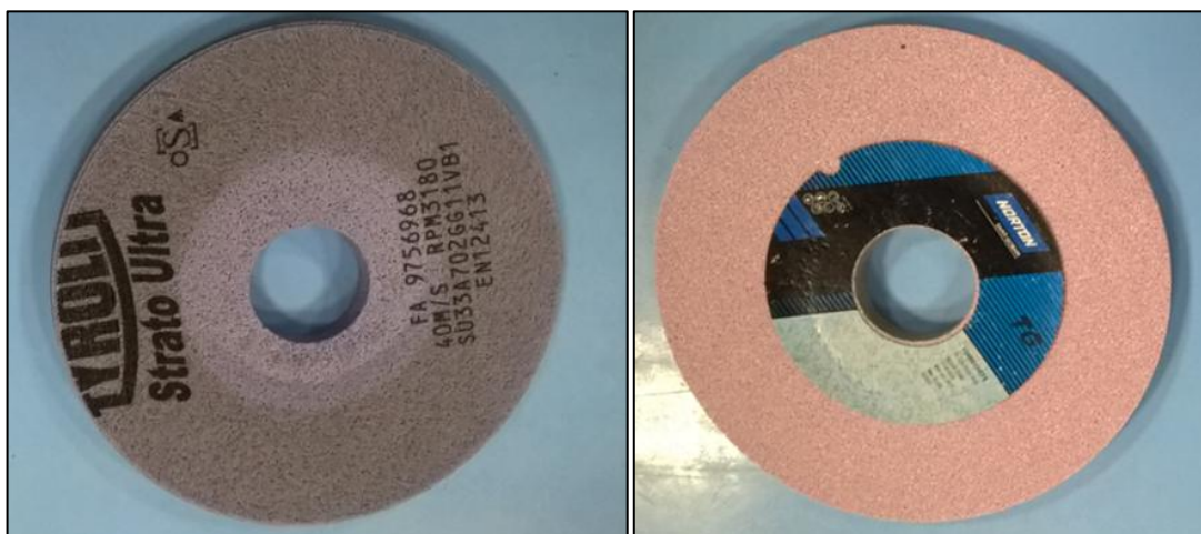
Obrázek 35 Tyrolit STRATO-ULTRA 240x15x51 33A 702GG11V B1/40 (vlevo) a NORTON ALTOS 01 225x15x50,8 TGX80D13VCF5 (vpravo)
