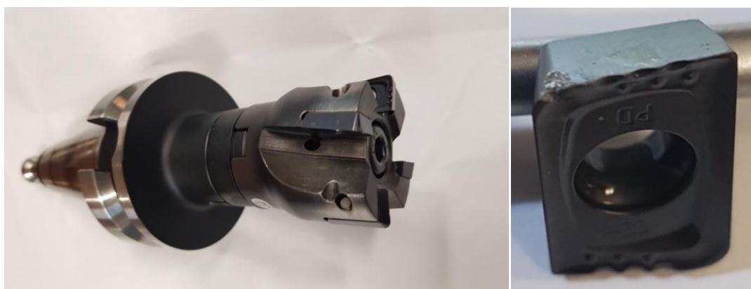
Obrázek 27 Nástrčná fréza s VBD (vlevo) a VBD po jednom průchodu (vpravo)
