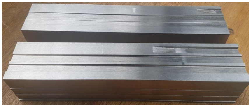
Obrázek 44 Hranoly s drážkami po hloubkovém broušení
