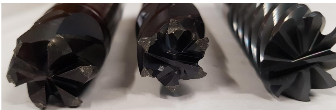
Obrázek 29 Použité monolitní frézy (pro porovnání nová fréza vpravo)
