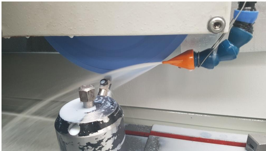
Obrázek 33 Kotouč při orovnávaní boků
