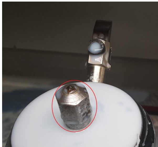
Obrázek 47 Nasazený monokrystalový hrot orovnávače
