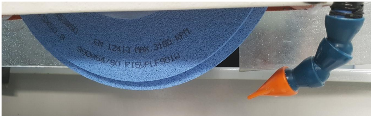
Obrázek 34 Orovnaný kotouč na šířku 7mm
