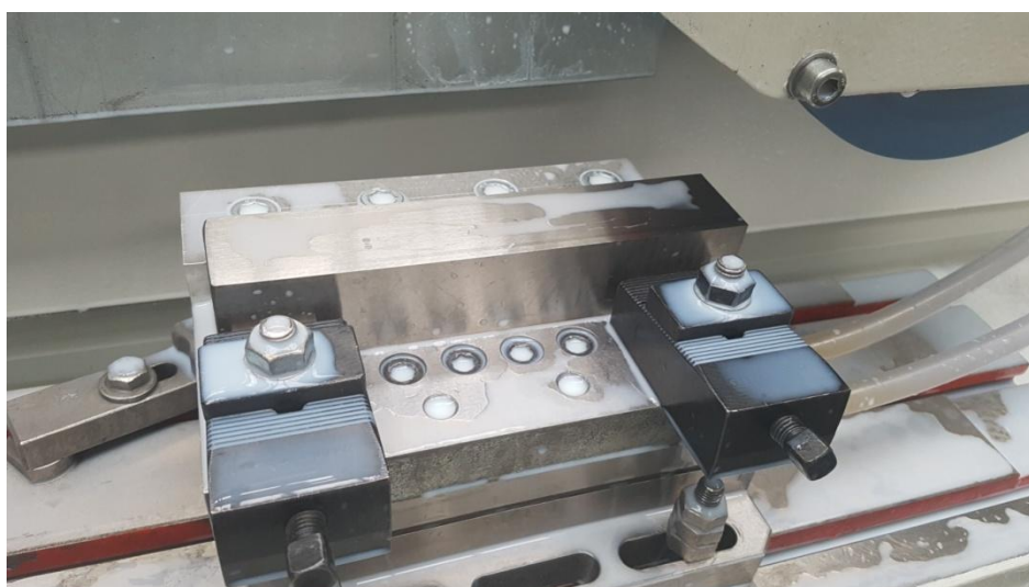
Obrázek 31 Upnutý hranol pro broušení horní plochy
