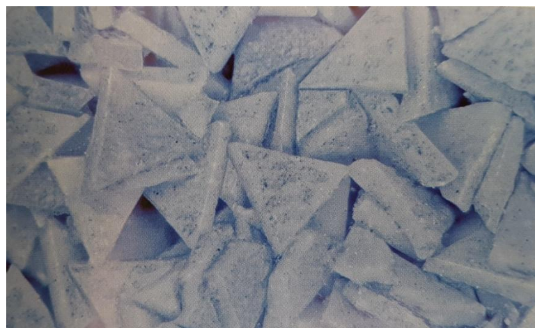
Obrázek 40 Trojúhelníková zrna kotouče Cubitron™ II [12]
