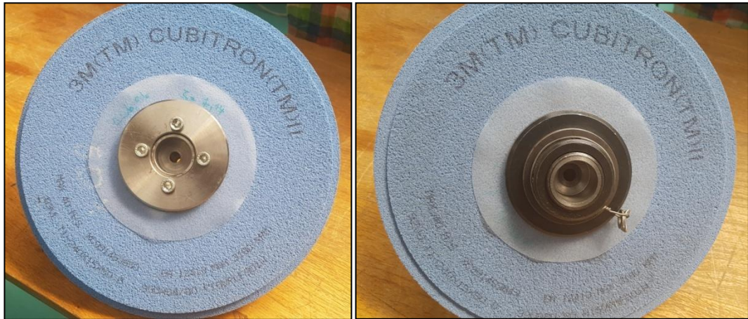
Obrázek 36 Cubitron™ II 99% 240x15x50,8 99DA54/80 F15VPLF901W (vlevo) a Cubitron™ II 30% 240x15x50,8 93DA80/80 H15VPMF601W (vpravo)
