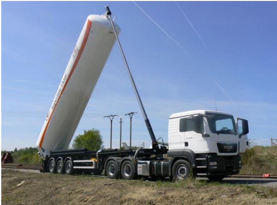
Obr.7: Maximální sklopení cisterny při vyprazdňování přepravníku, převzato z [1]
