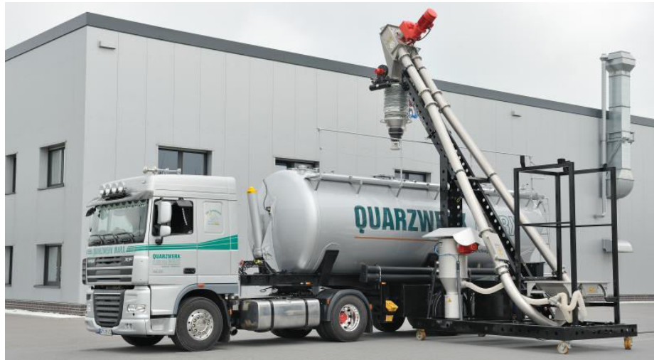
Obr.5: Přistavení přepravníku pod plnicí terminál, převzato z [2]
