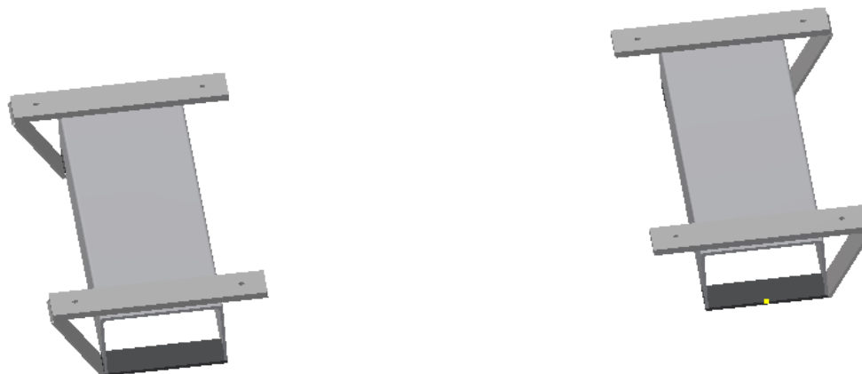
Obr. 32. - Druhá varianta spodního rámu
