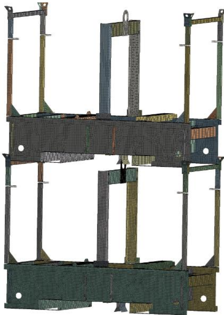
Obr. 63. - Zastohovaná rámové konstrukce
