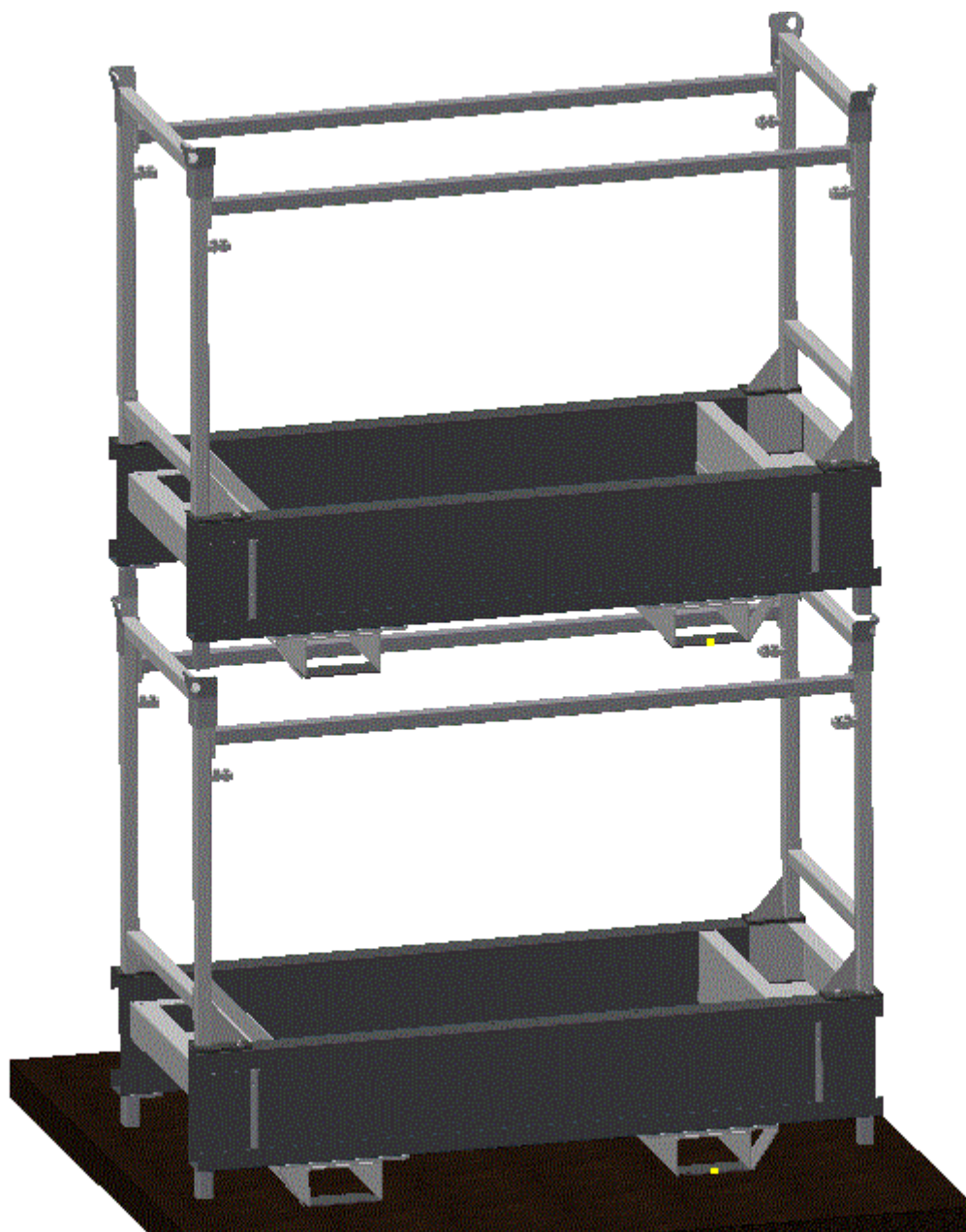
Obr. 40. - Zastohované rámy (druhá konstrukční varianta)
