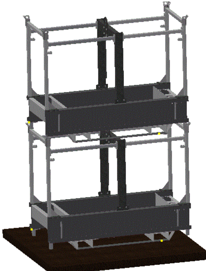
Obr. 38. - Zastohované rámy (první konstrukční varianta)
