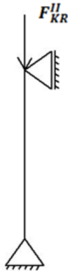
Obr. 36. -Zvolený případ vzpěru
