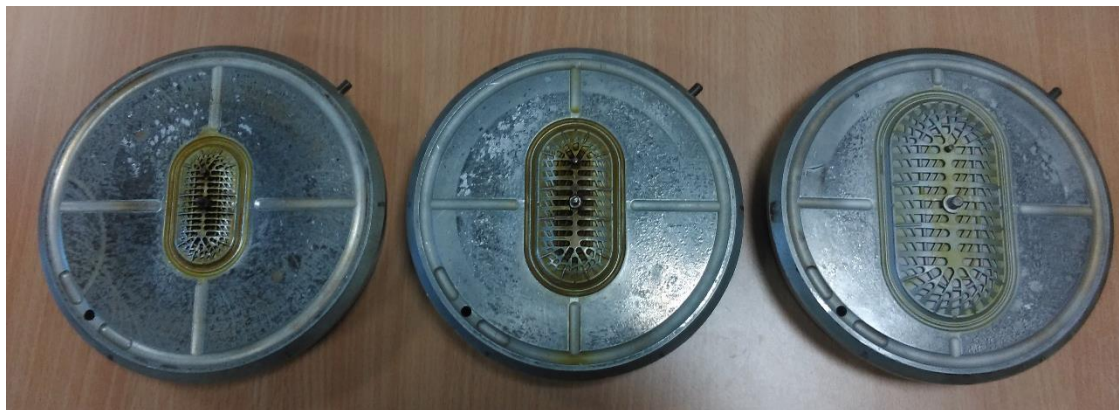
Obr. č. 30 - Původní formy na přísavky (vlevo 60-30PF, uprostřed 80-40PF, vpravo 110-55PF)
