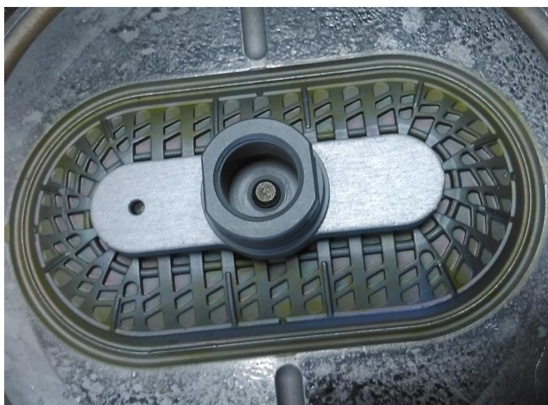
Obr. č. 34 – Nasazená vložka na dolní polovinu formy
