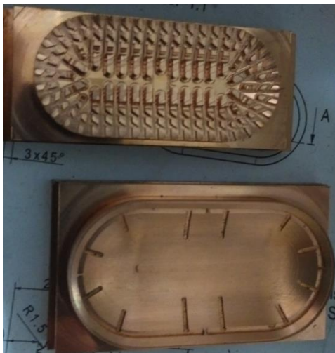
Obr. č. 58 – Měděné elektrody na vložku tvaru pro přísavku (nahore – dokončovací, dole – hrubovací)
