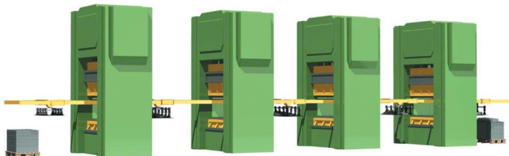
Obr. č. 14 - Přemísťování plechů při lisování [6]
