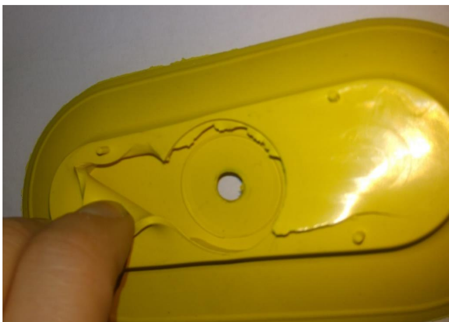
Obr. č. 65 - Testování 110-55PF na výskyt slabších míst a vzduchových kapes
