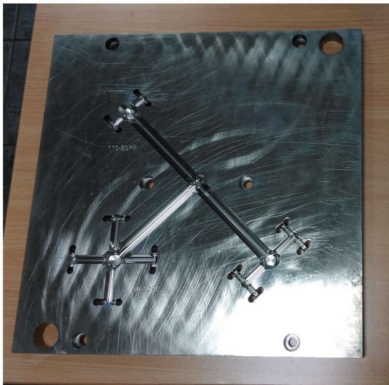
Obr. č. 59 – Rozváděcí deska
