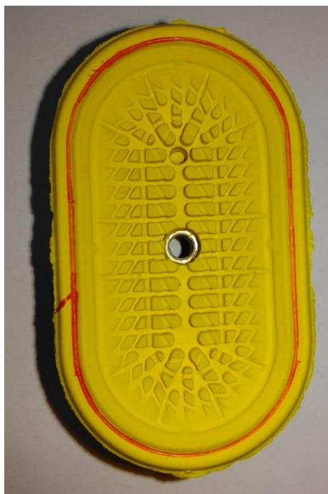
Obr. č. 38 - Přísavka vyndaná z formy s naznačenou dráhou k ostřížení
