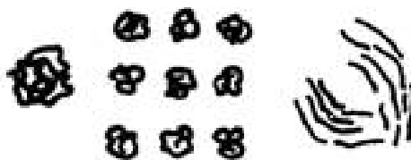
Obrázek 3: Nadmolekulární struktura amorfních plastů – globula (vlevo), uspořádání globul (uprostřed), svazek (vpravo) [4]
