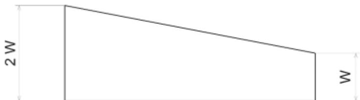
Obr. 36 – Náhradní rozložení tlaku na vyvažovací plošce [10]
