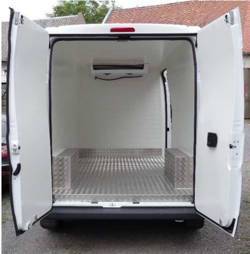
Obr.14 – Chladírenská vestavba (vnitřní pohled)
