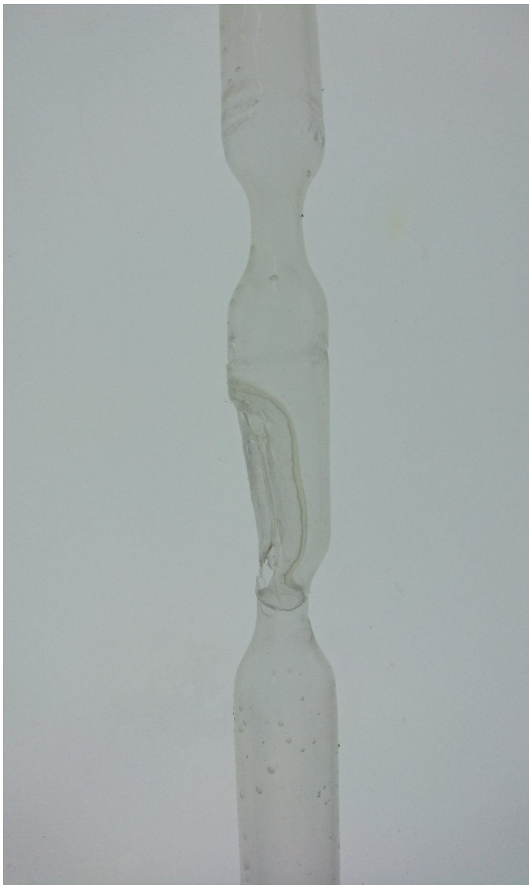
Příloha III - obr. 15 Model č. 3 (odlévaný do rotující formy) - detail vady 1
