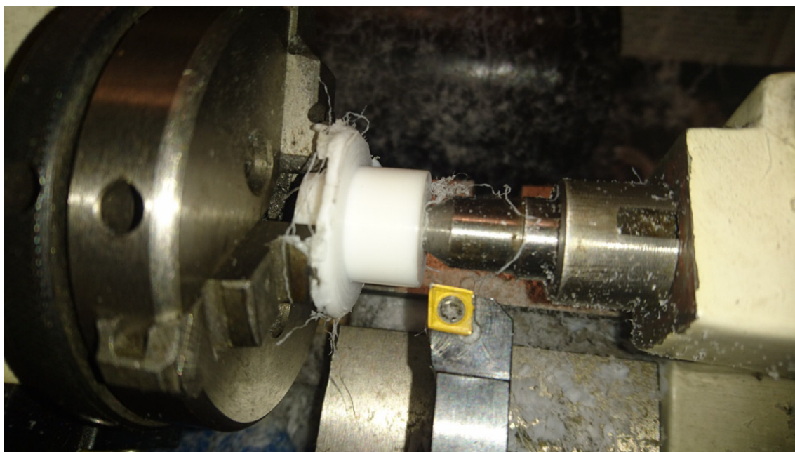
Příloha III - obr. 6 Výroba kluzného pouzdra do převodovky
