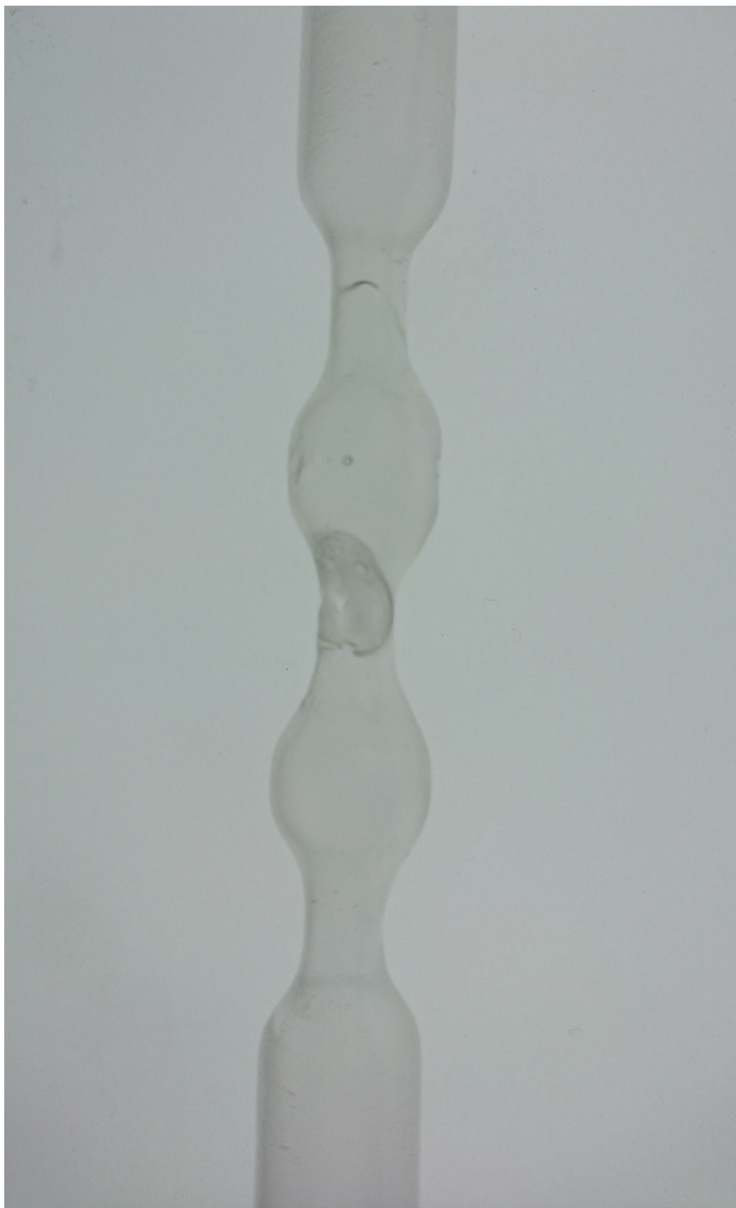
Příloha III - obr. 13 Model č. 2 (odlévaný do rotující formy) - detail vady
