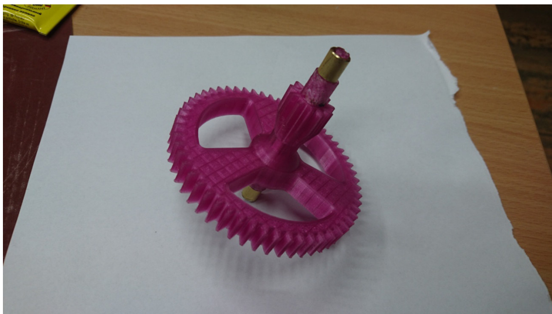
Příloha III - obr. 4 Vytisknuté ozubené kolo (předlohové) s mosaznými pouzdry (pohled 2)
