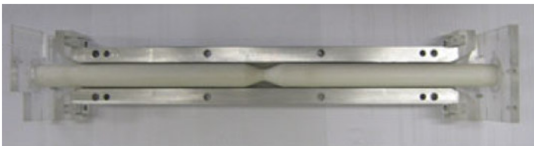
Obr. 4.5 Dělená forma s jádrem – převzato a upraveno [2]
