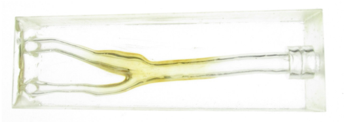
Obr. 4.2 Odlitý tuhý model karotické bifurkace
