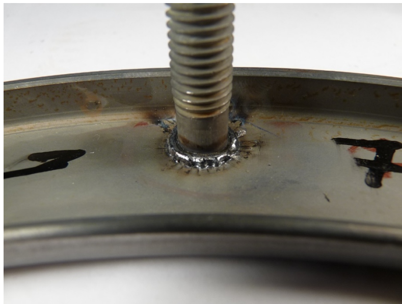
Obr. 4.6 - Vzorek č. 4 - přivařený svorník za podmínek 700 A a 280 ms
