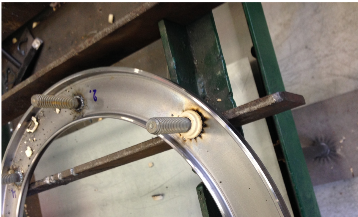
Obr. 4.18 - Přivařený svorník s neodstraněným keramickým kroužkem
