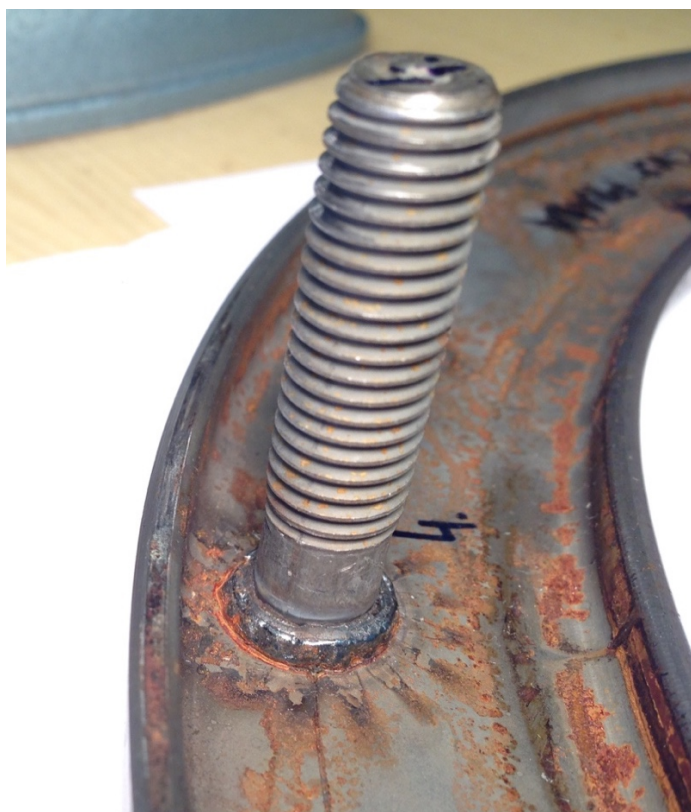
Obr. 4.11 - Svorník ( I = 700\text{ A} a t = 280\text{ ms} ) po vyjmutí z cyklické zkoušky
