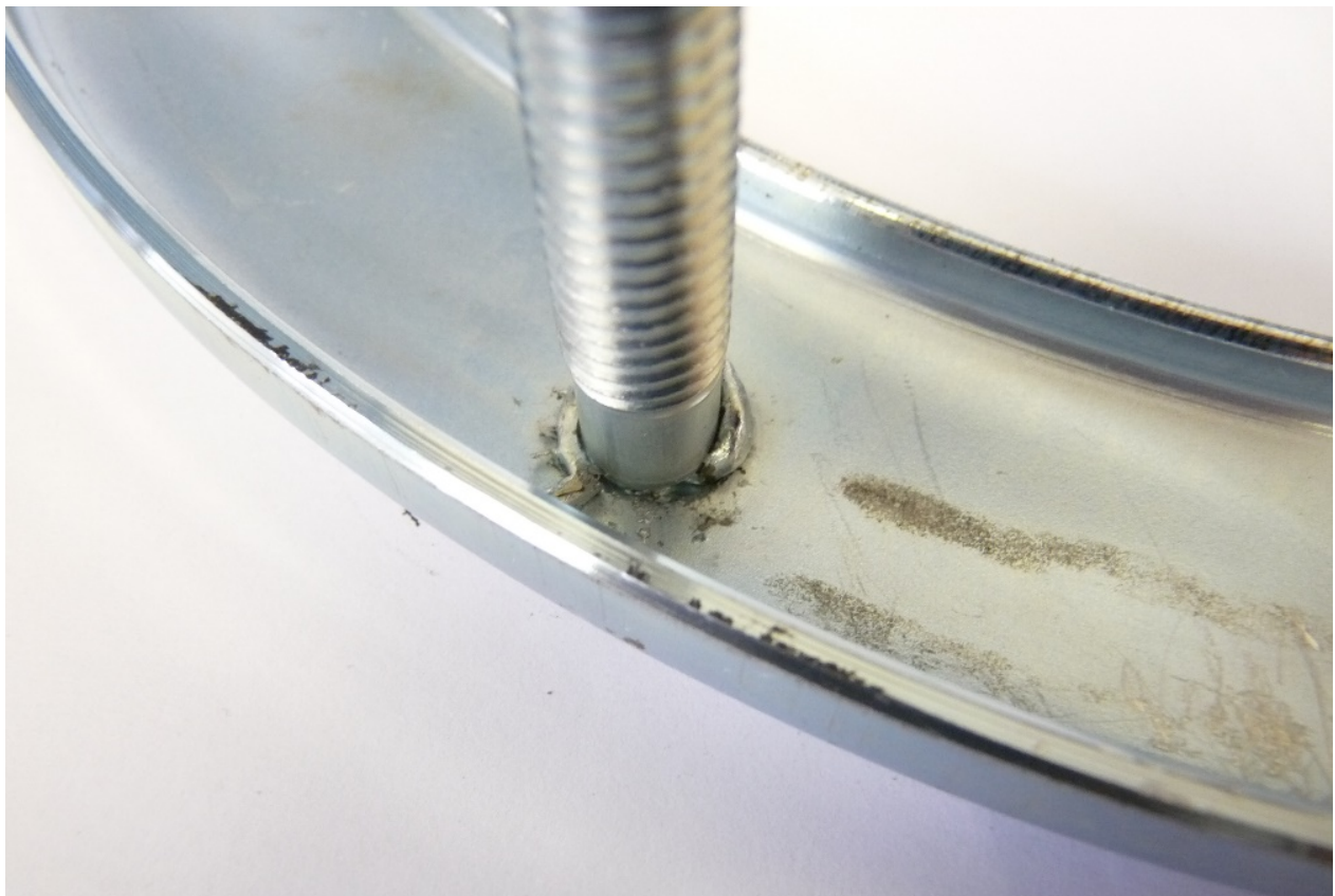
Obr. 3.8 - Vizuální kontrola přivařeného svorníku
