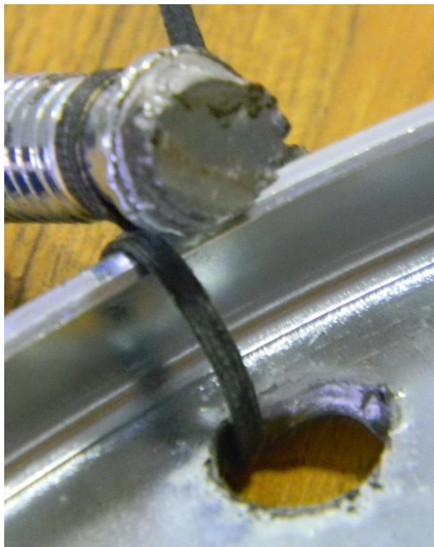
Obr. 3.7 - Svorník po zkoušce životnosti
