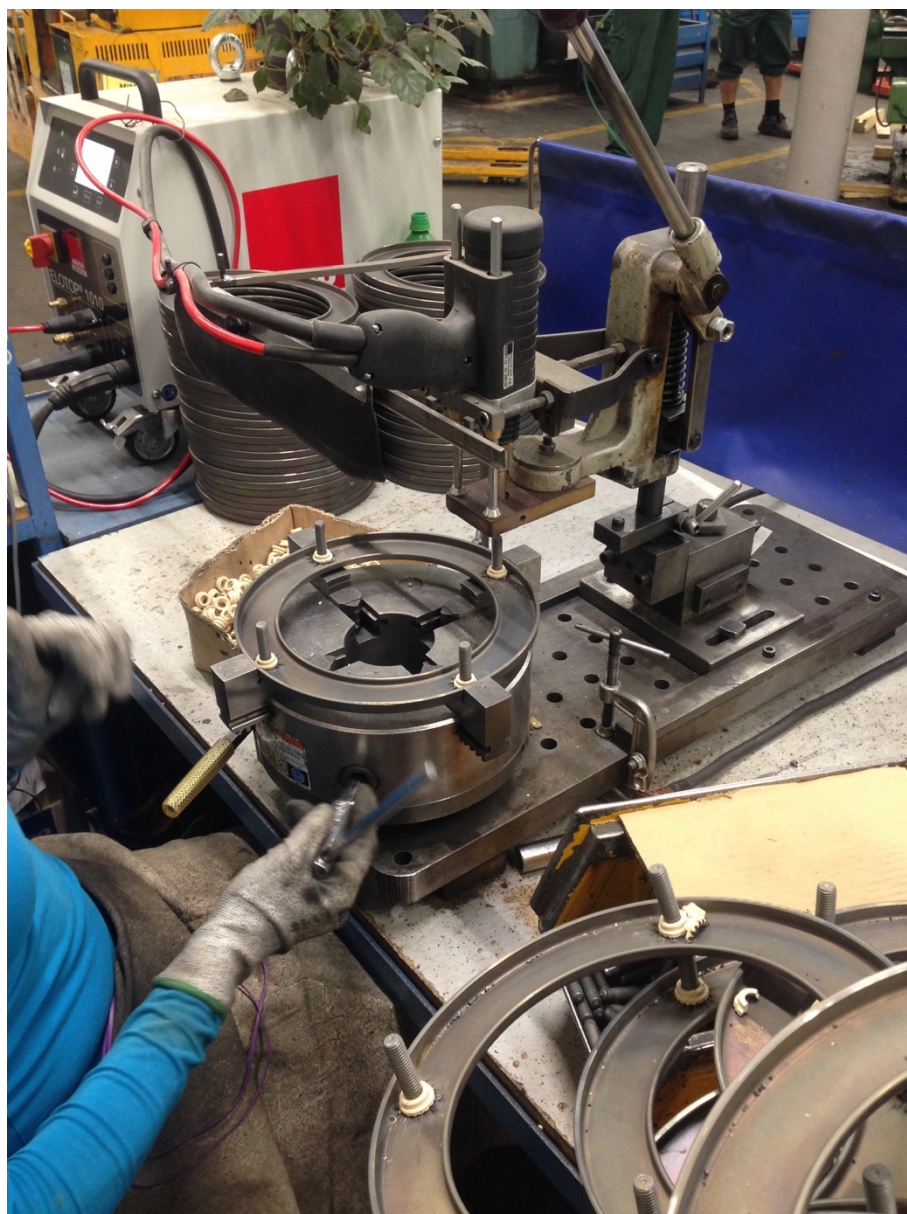
Obr. 4.10 - Zařízení pro přivařování svorníků – reálná poloautomatická výroba u externího dodavatele
