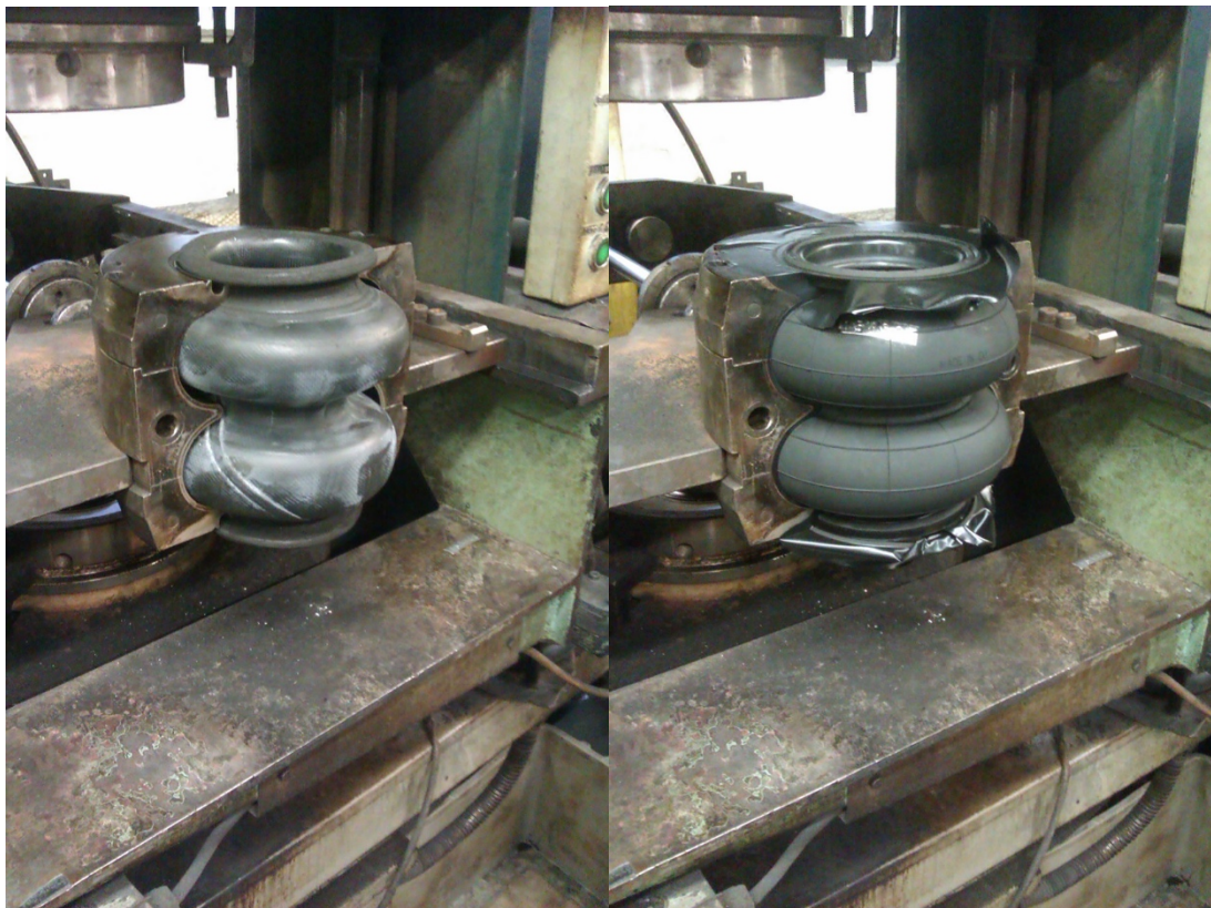
Obr. 1.6 - Vzduchová pružina před a po vulkanizaci
