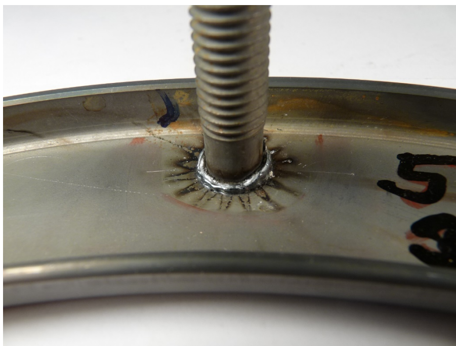
Obr. 4.4 - Vzorek č.3 – přivařený svorník za podmínek 520 A a 300 ms
