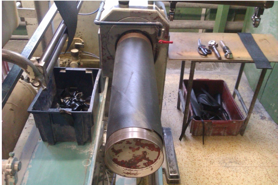
Obr. 1.3 - Válec pro tvorbu polotovaru
