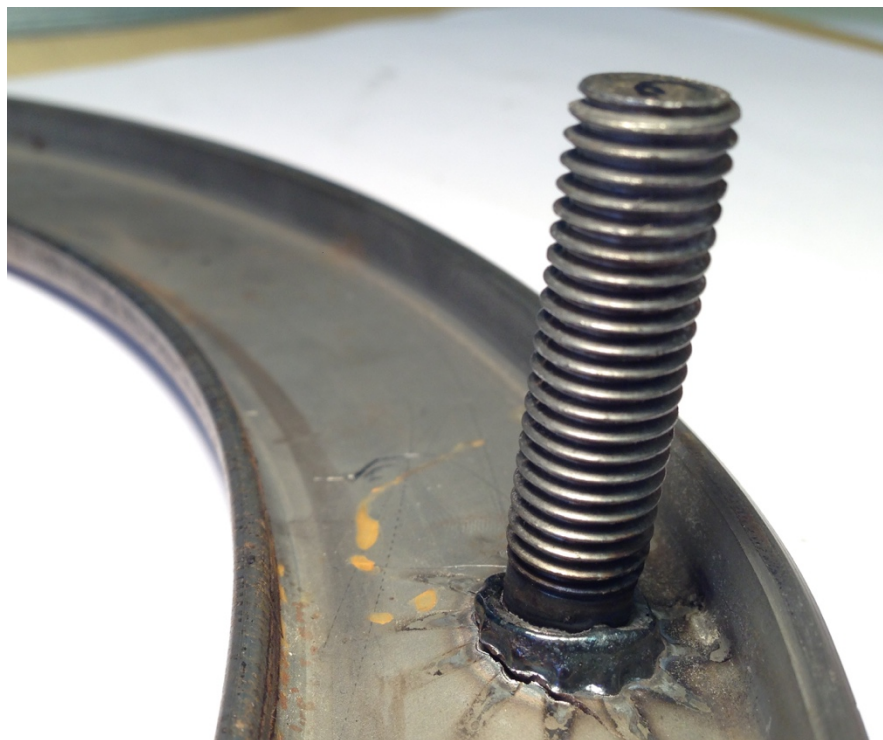
Obr. 4.14 - Svorník ( I = 700\text{ A} a t = 240\text{ ms} ) po vyjmutí z cyklické zkoušky
