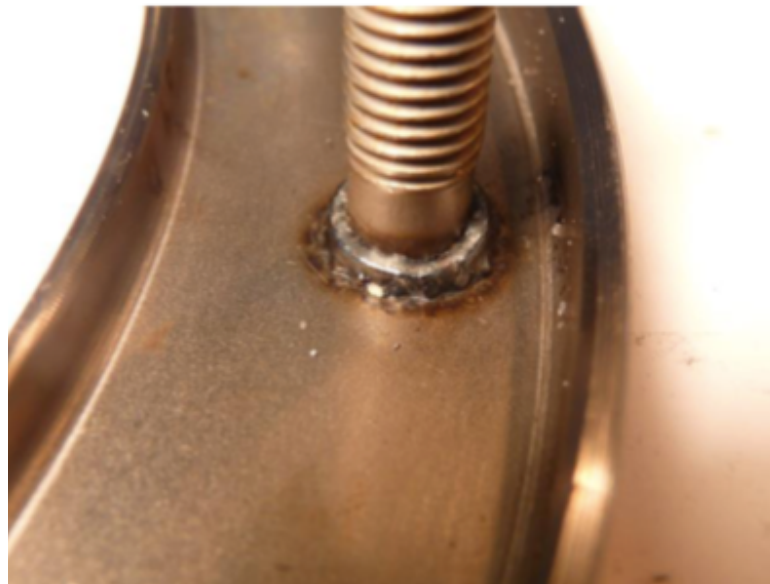
Obr. 4.8 - Vzorek č. 5 - přivařený svorník za podmínek 700 A a 240 ms
