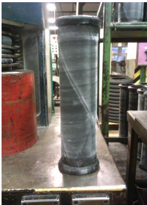
Obr. 1.4 - Polotovar vyváln v brusném prachu
