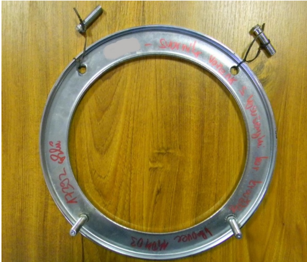
Obr. 3.6 - Svorník po zkoušce životnosti
