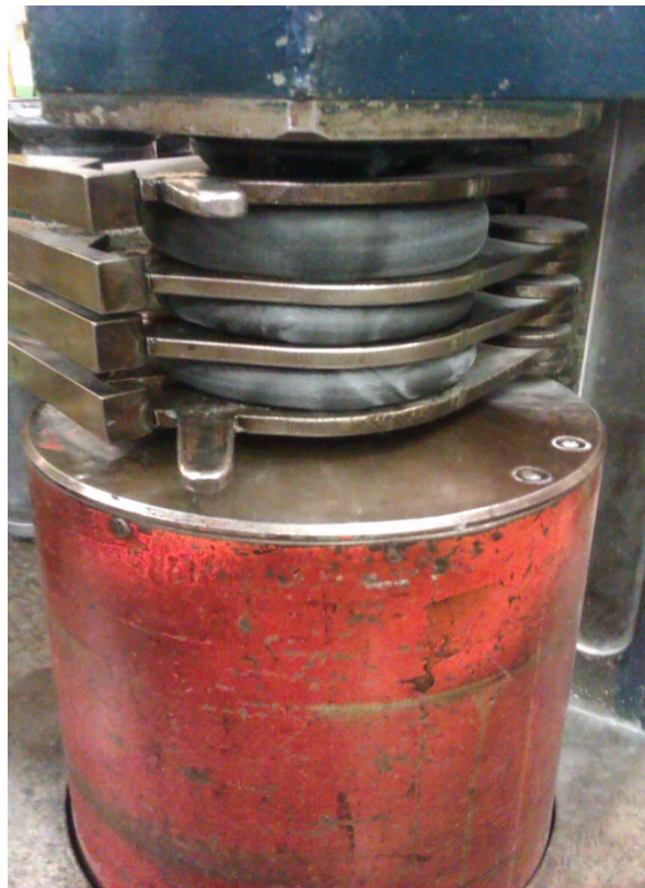
Obr. 1.5 - Bombírování vzduchové pružiny
