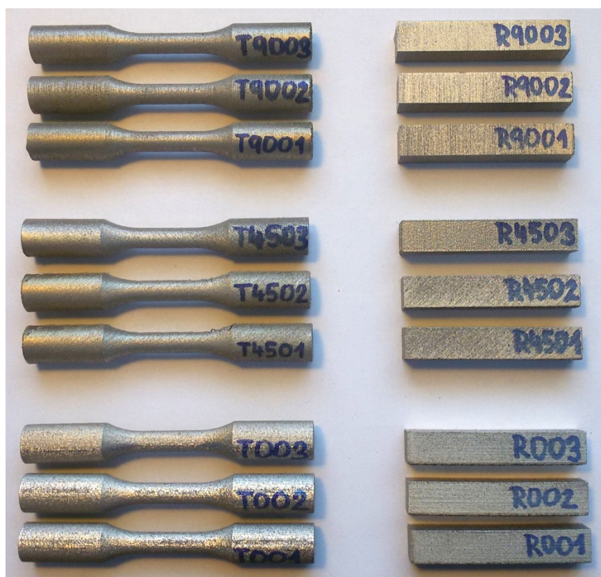
Obrázek 4.10 Sada zkušebních těles po odstranění podpěr a označení
