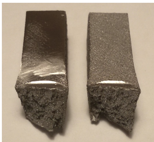
Obrázek 5.38 Zkušební těleso R4503 – plocha lomu
