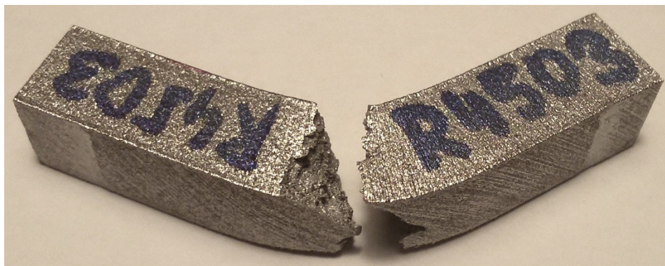
Obrázek 5.37 Zkušební těleso R4503 po přeražení
