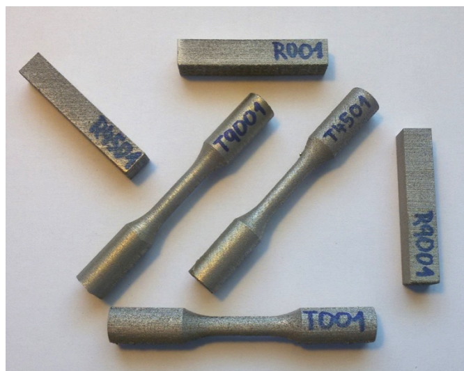
Obrázek 4.9 Zkušební tělesa po odstranění podpěr
