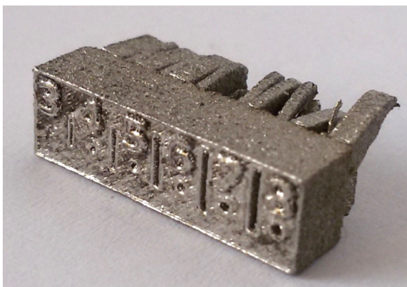
Obrázek 4.3 Zkušební těleso pro analýzu průchozích otvorů realizované technologií DMLS
