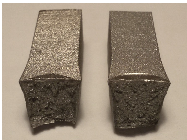
Obrázek 5.40 Zkušební těleso R9001 – plocha lomu
