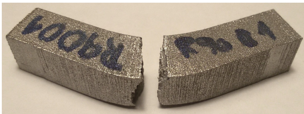
Obrázek 5.39 Zkušební těleso R9001 po přeražení
