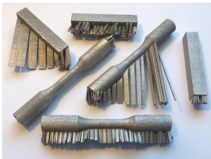
Obrázek 4.8 Zkušební tělesa před odstraněním podpěr
