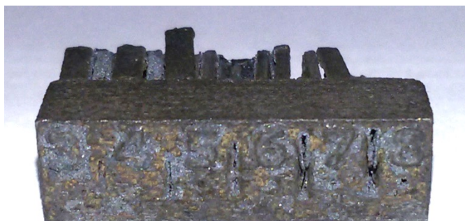
Obrázek 5.1 Zokujený povrch vzorku po TZ bez ochranné atmosféry
