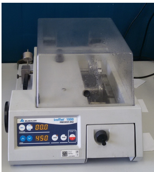
Obrázek 4.17 Přesná metalografická pila Buehler IsoMet 1000
