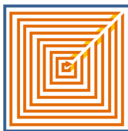
Obrázek 3.14 Princip strategie "Total Fill" [13]
