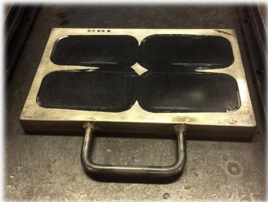
Obrázek 5.20: Zvulkanizované pryžové výlisky s přetoky ve formě
