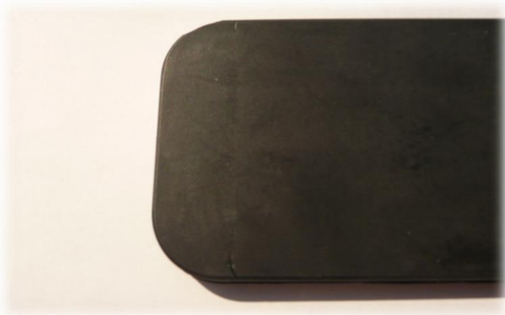
Obrázek 5.23: Vada vyskytující se na vzorku bez reliéfu u 4. série
