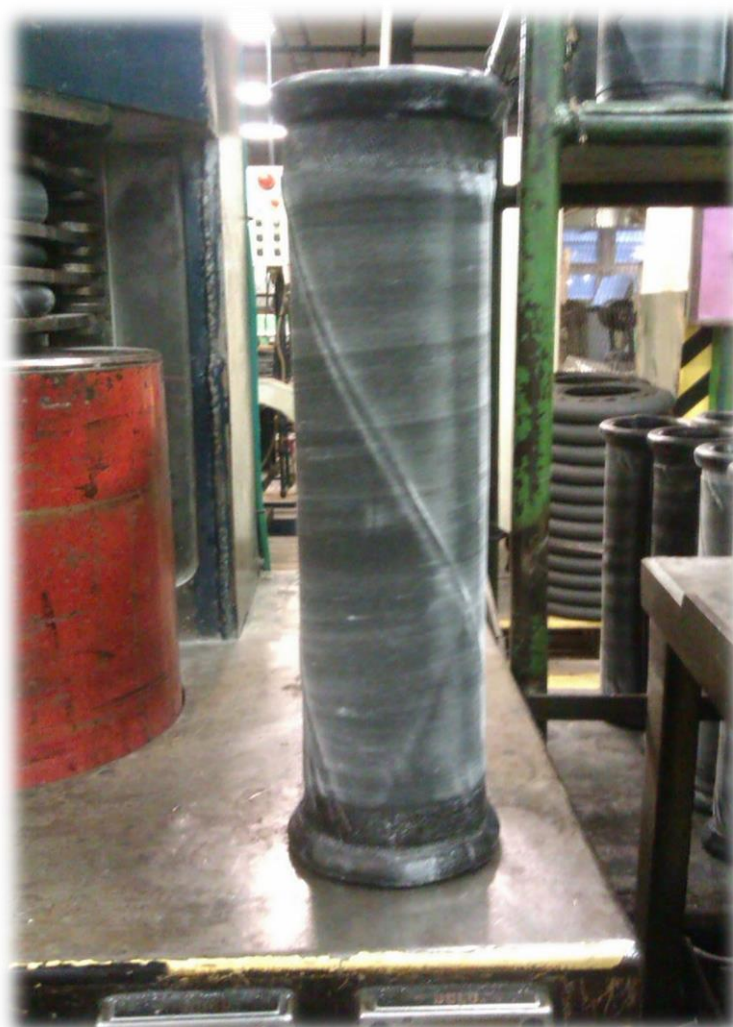
Obrázek 3.5: Polotovar po dokončení konfekce
