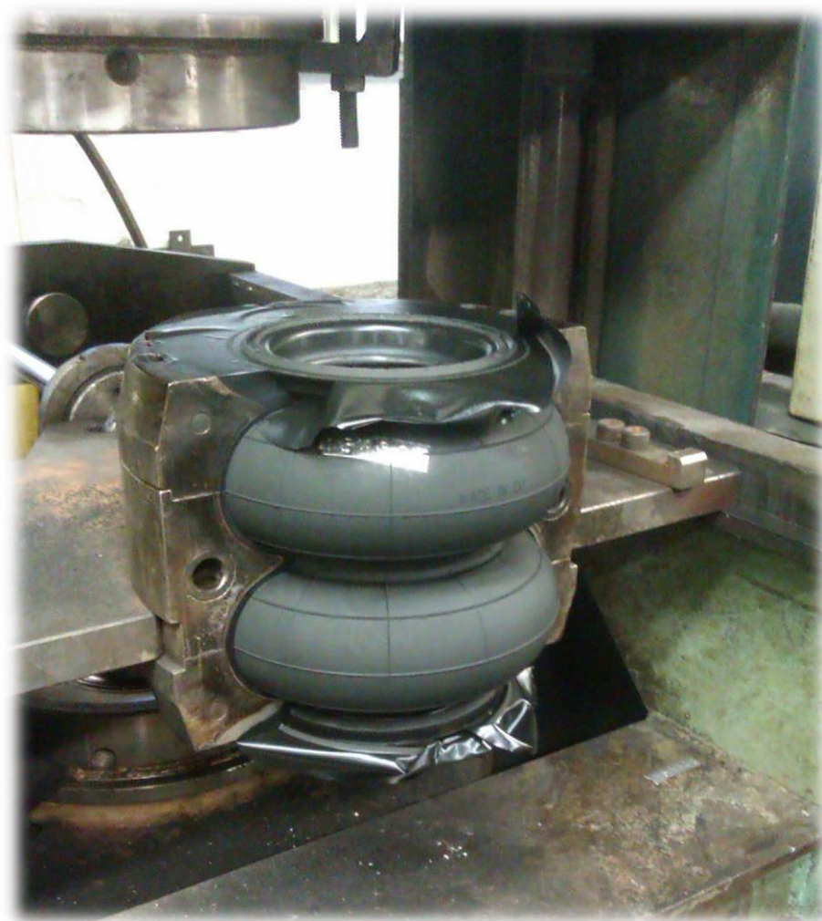
Obrázek 3.8: Vlnovec ve formě po vulkanizaci
