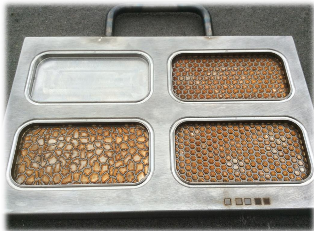
Obrázek 5.16: Neočištěná forma s otřepy a opalem
