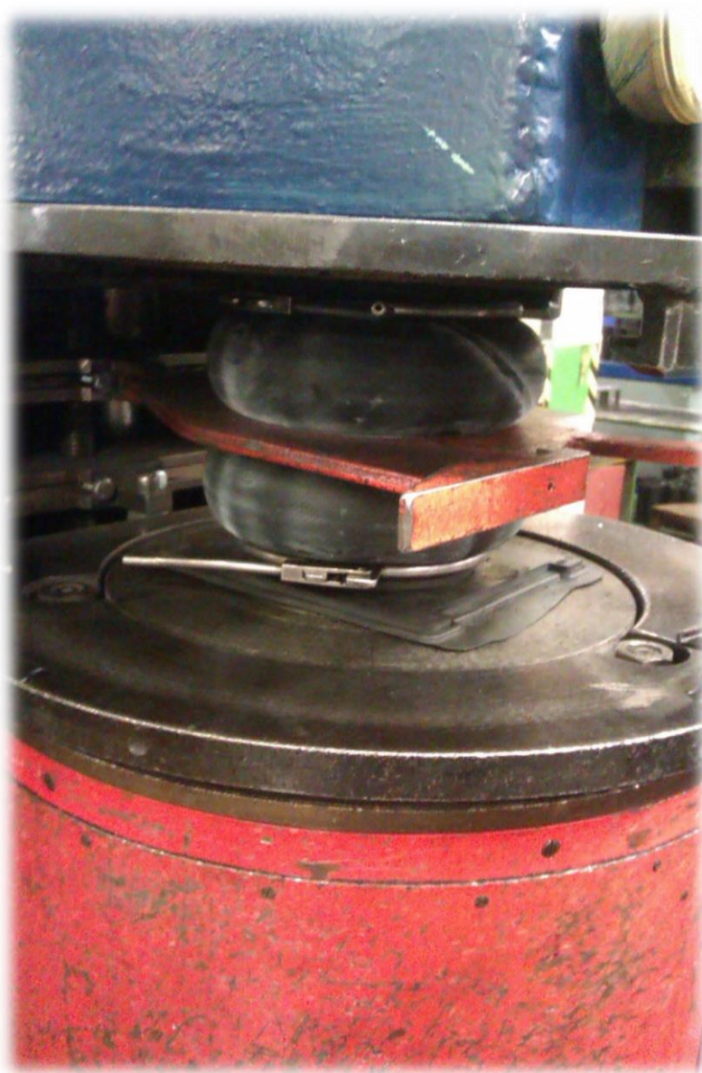
Obrázek 3.6: Bombírka při natlakování a stlačení polotovaru
