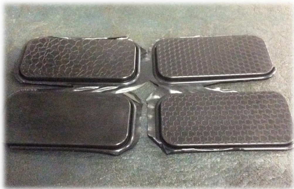
Obrázek 5.21: Zkušební vzorky po vulkanizaci s přetoky
