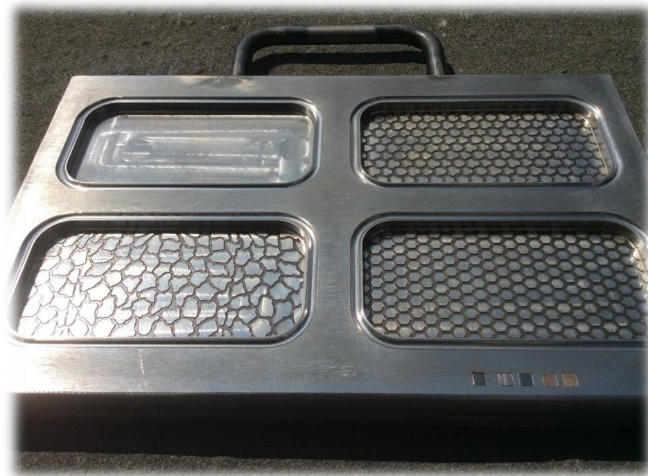
Obrázek 5.17: Vybroušená forma připravená k použití
