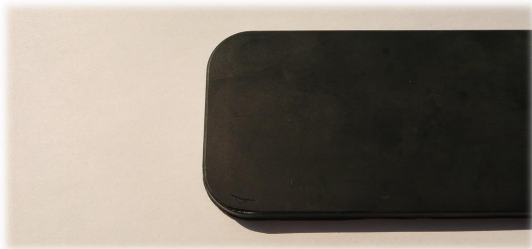
Obrázek 5.24: Vada vyskytující se na vzorku bez reliéfu u 11. série
