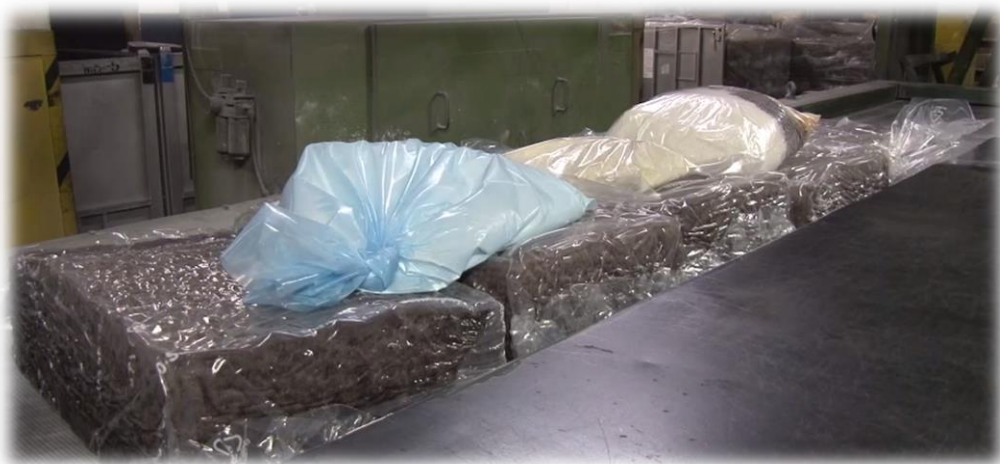
Obrázek 3.1: Automaticky navážené přísady kaučukové směsi
