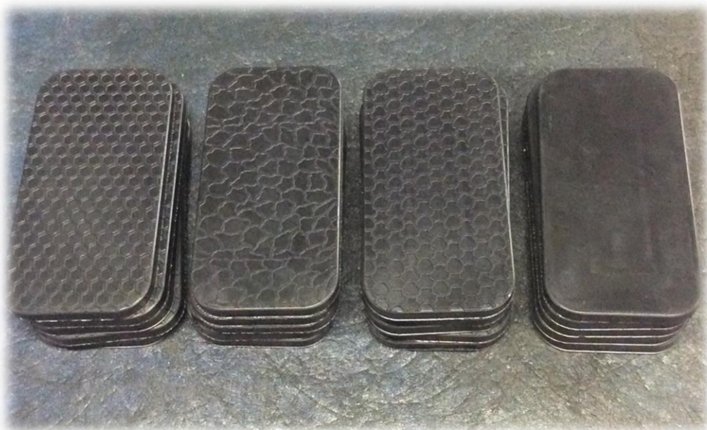
Obrázek 5.22: Zkušební vzorky po vulkanizaci bez přetoků
