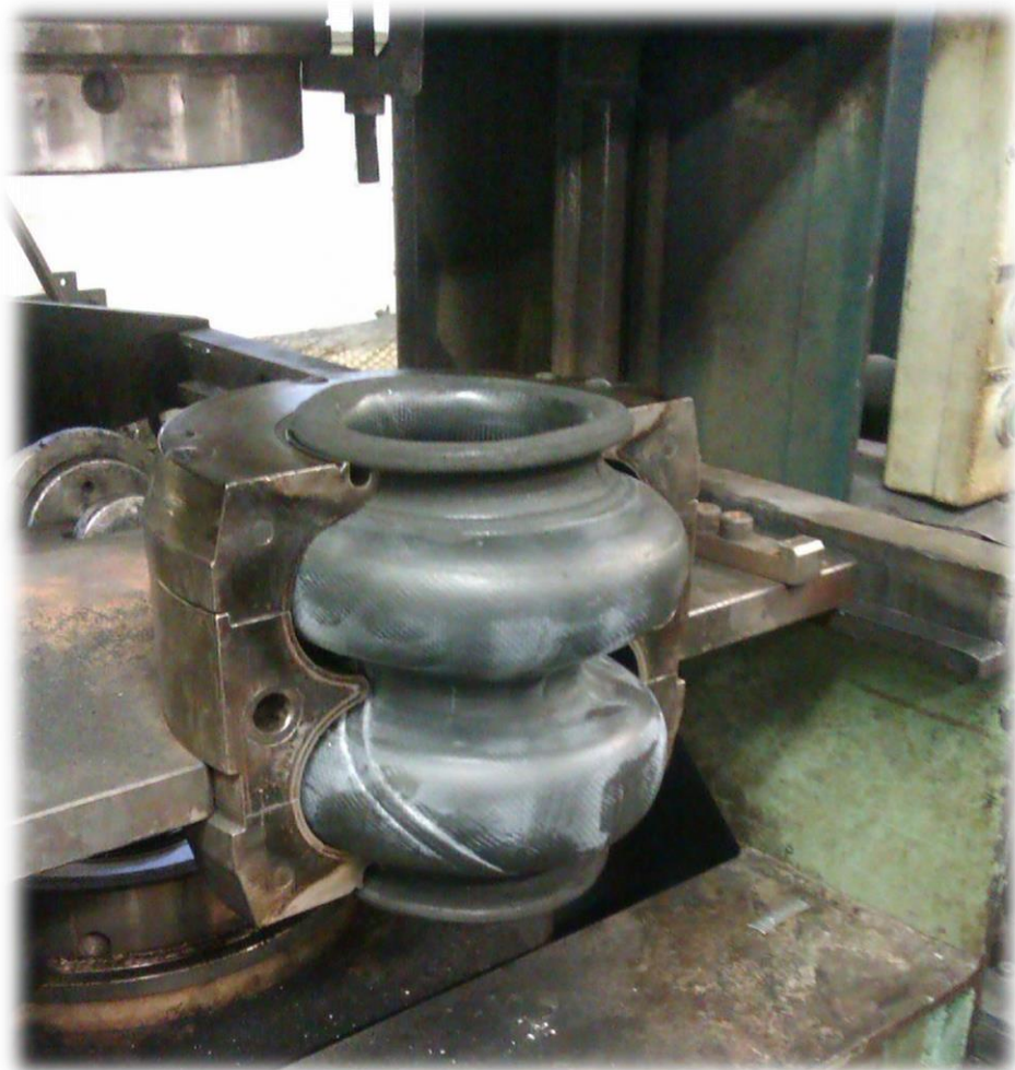
Obrázek 3.7: Vlnovec ve formě před vulkanizací
