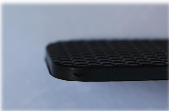
Obrázek 5.25: Vada vyskytující se na vzorku s pravidelným reliéfem u 7. série
