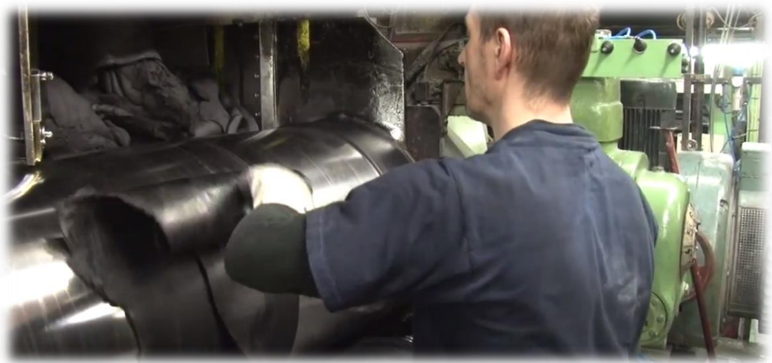
Obrázek 3.3: Míchání a odkrajování směsi na dvouválci
