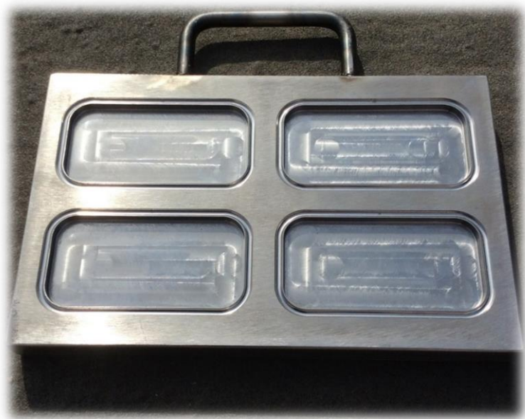
Obrázek 5.7: Zkušební forma pro vzorky z kaučukové směsi
