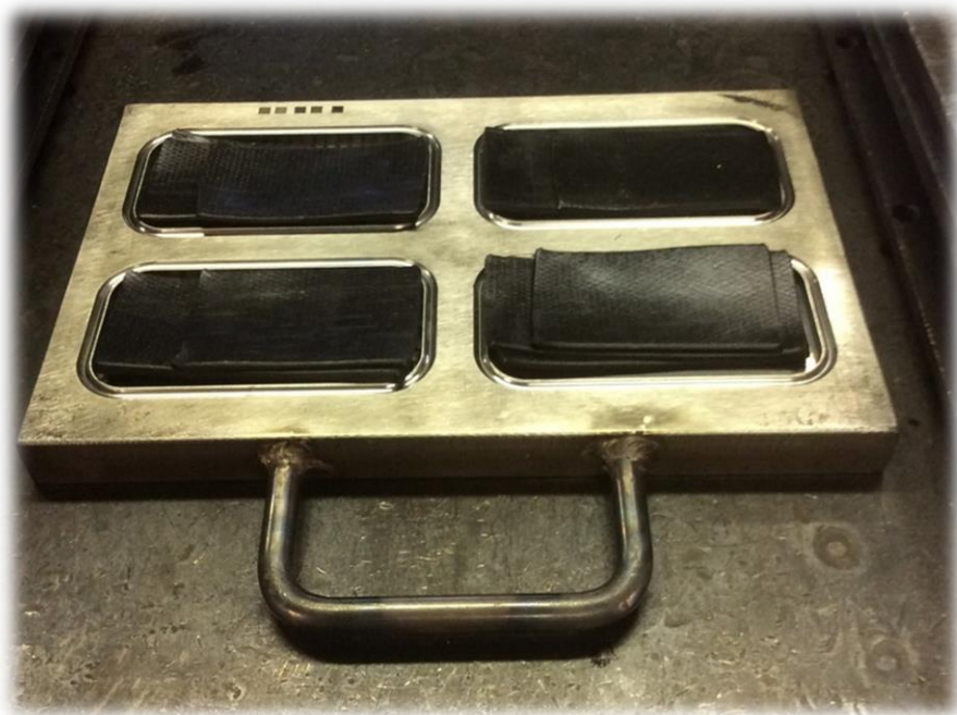
Obrázek 5.19: Příprava kaučukové směsi ve formě před vulkanizací
