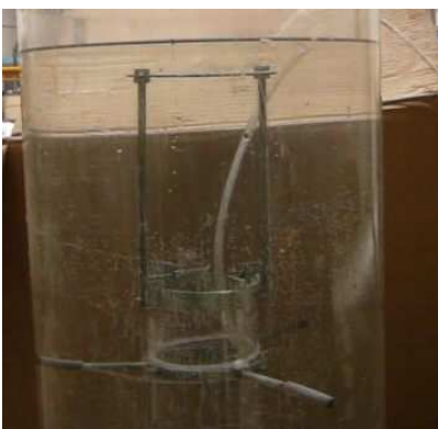
Obr. 4.1.3 Nastavitelná výška usměrňovací desky:
