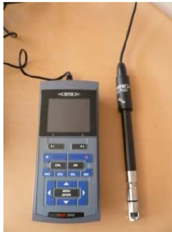
Obr. 4.3.1 Přenos hmoty k_L a : měřící sonda:
