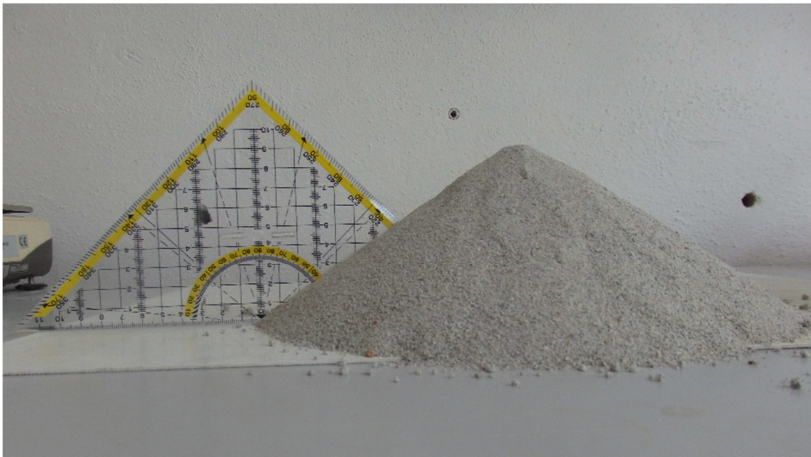
Obr. 3-39 Zkouška sypným úhlem vzorku B3 45,0-45,3
