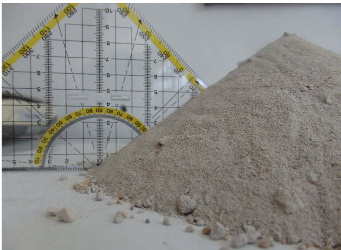
Obr. 3-40 Zkouška sypným úhlem vzorku B4 22,1-22,5
