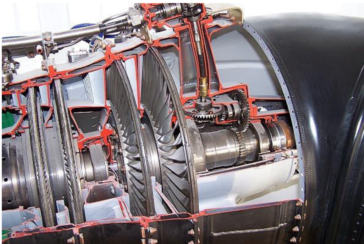
Obr. 6: Řez motorem TV3-117 – dvoustupňová turbína (vlevo), pohánějící kompresor a volná turbína (vpravo), pohánějící rotor a agregáty [17]
