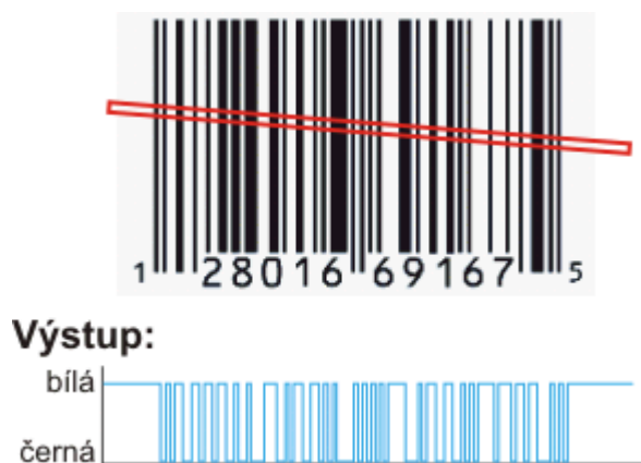
Obr. 4 CCD čip jako čtečka čárového kódu [5]
