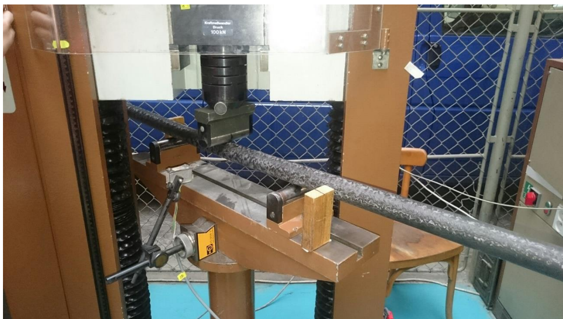
Obr. 16 Silnostěnný nosník – měření průhybu 1
