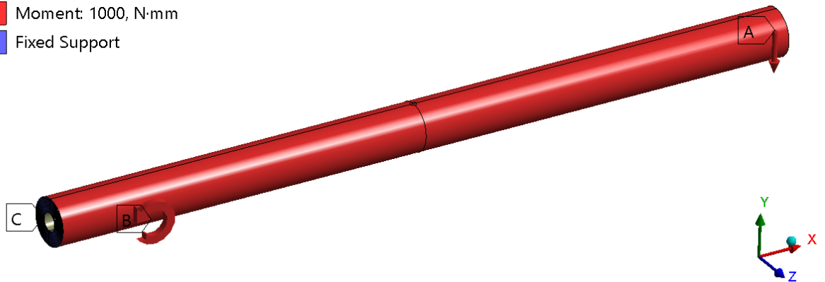
Obr. 24 Trubka 1 - okrajové podmínky a zatížení pro objemovou skořepinu – ohyb + smyk
