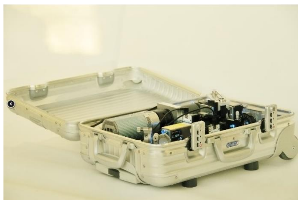
Obr. 21.: SPIM umístěný v přenosném kufříku [23]
