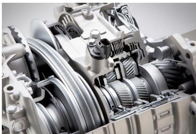
Obr. 5: Diferenciální variátor Kappa od Hyundai [8]
