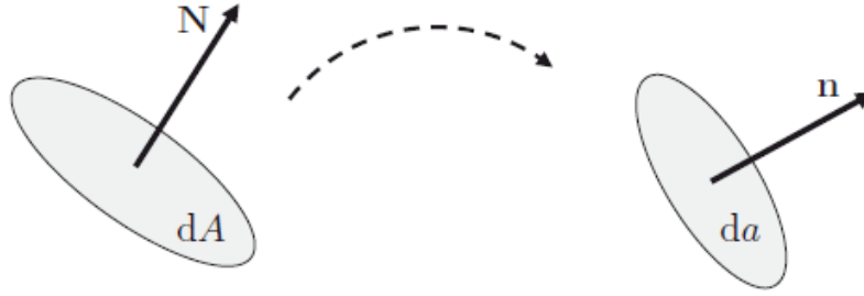
Obrázek 15: Transformace \mathbf{N}dA z referenční konfigurace na \mathbf{n}da v konfiguraci referenční [12]
