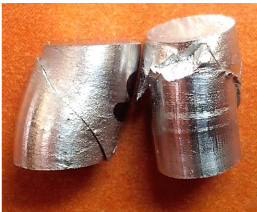
Obrázek 56 – Prasknutí vzorků bez vady a s vadou
