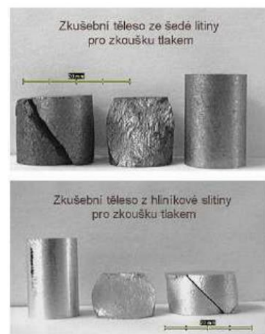
Obrázek 19 – Reálná podoba vzorků před a po zatížení [20]
