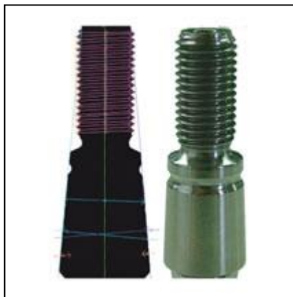
Obrázek 9 Příklad úlohy kontroly tolerancí: měření závitu a kužele na kulovém čepu [1]
