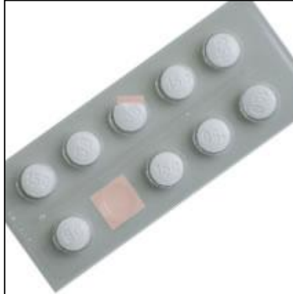
Obrázek 8 Příklad úlohy počítání: kontrola naplnění blistru s léky [1]
