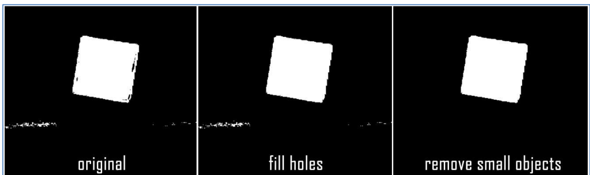
Obrázek 42 zleva: původní binarizovaný černobílý obraz, zaplnění děr v objektu, odstranění malých objektů
