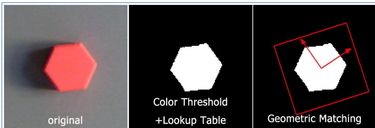
Obrázek 43 Postup obrazové inspekce od původního snímku dílce přes binarizaci až k samotnému rozpoznání tvaru
