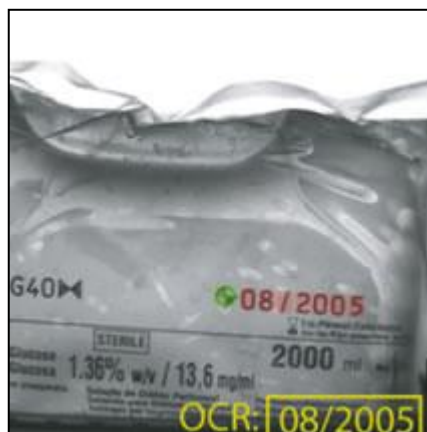
Obrázek 11 Příklad úlohy čtení textu: kontrola data výroby nebo expirace [1]
