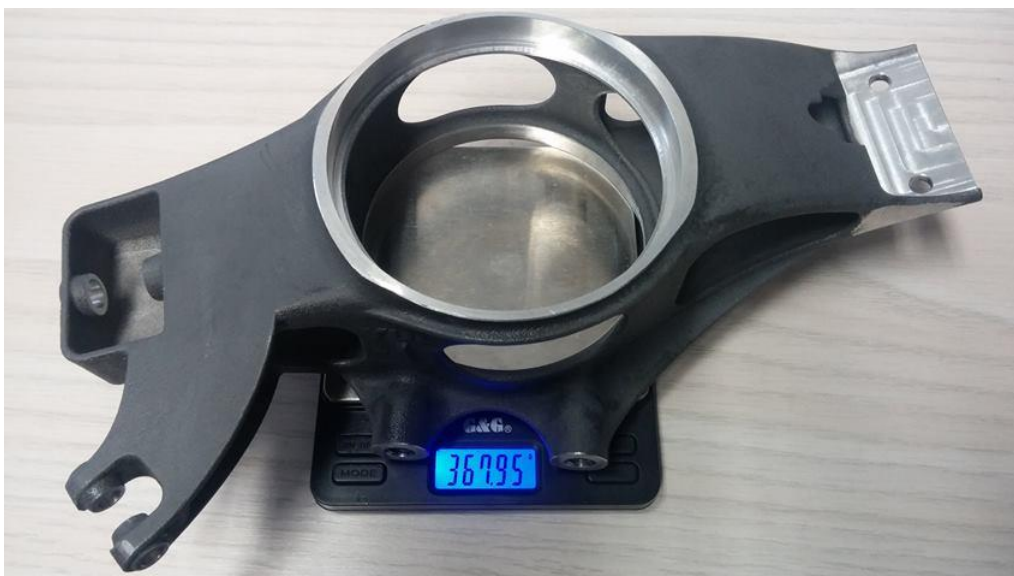
Obrázek 8 Odlévané těhlice týmu Racetech Freiberg [ (7) ]
