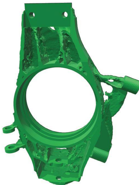
Obrázek 57 Výsledek topologické optimalizace při zadání výrobní podmínky v jednom směru
