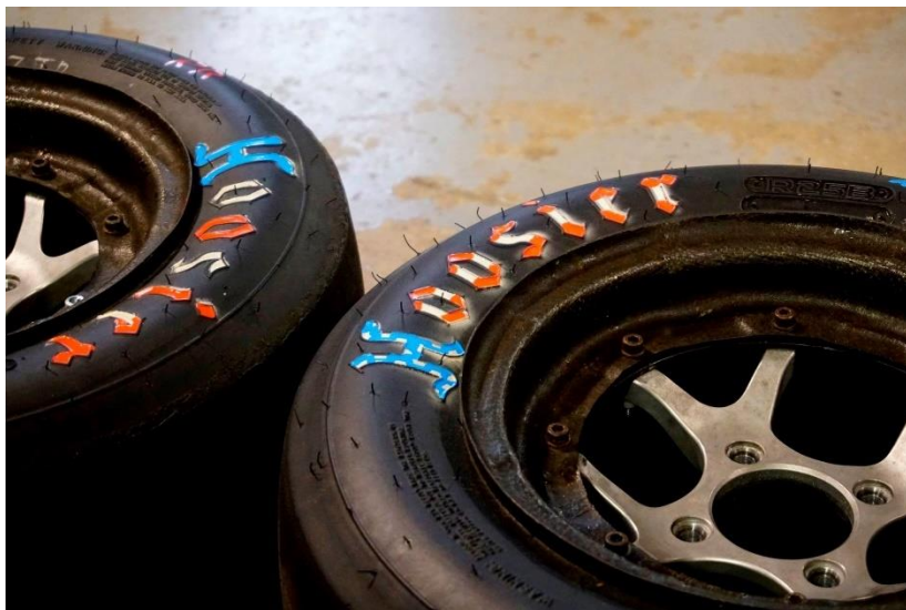
Obrázek 3 Uhlíkové ráfky s hliníkovými středy Rennteam Stuttgart [ (2)]
