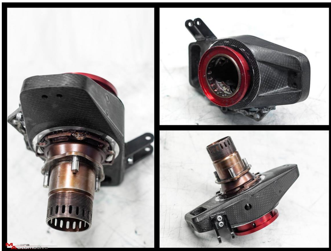
Obrázek 9 Kompozitní těhlice týmu TU Gratz [ (6) ]
