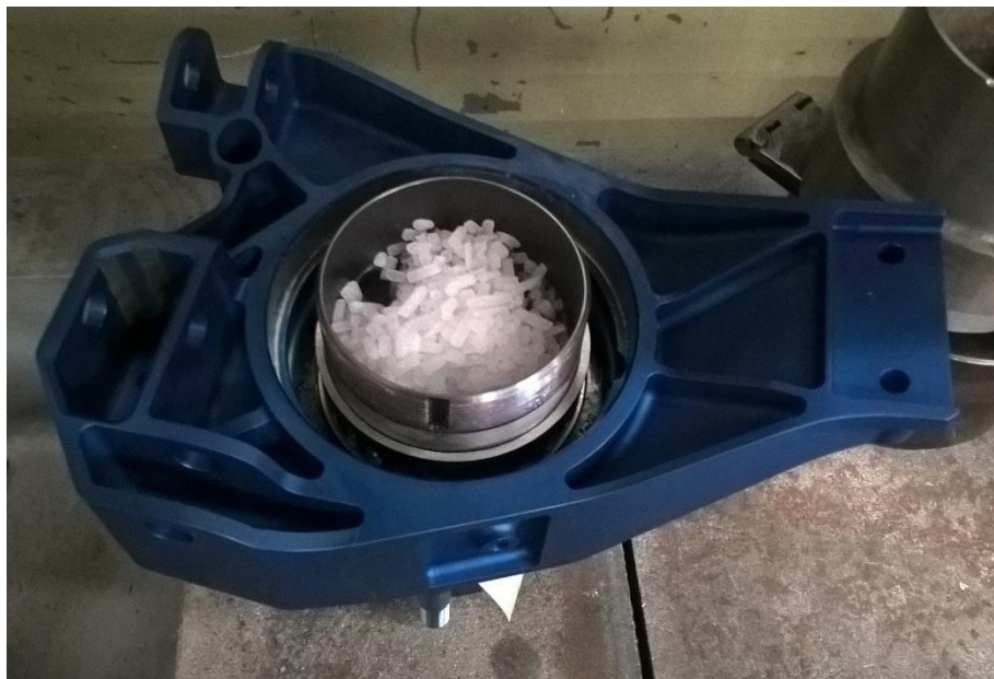
Příloha 5 Zadní těhlice vozu FS.08 při lisování ložisek
