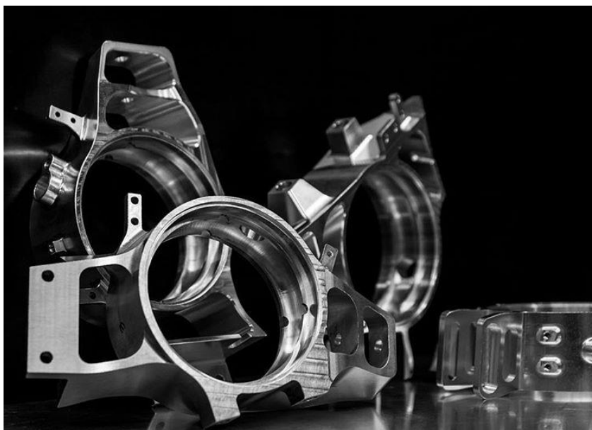
Obrázek 5 Obráběné těhlice týmu Rennstall Esslingen [ (4) ]
