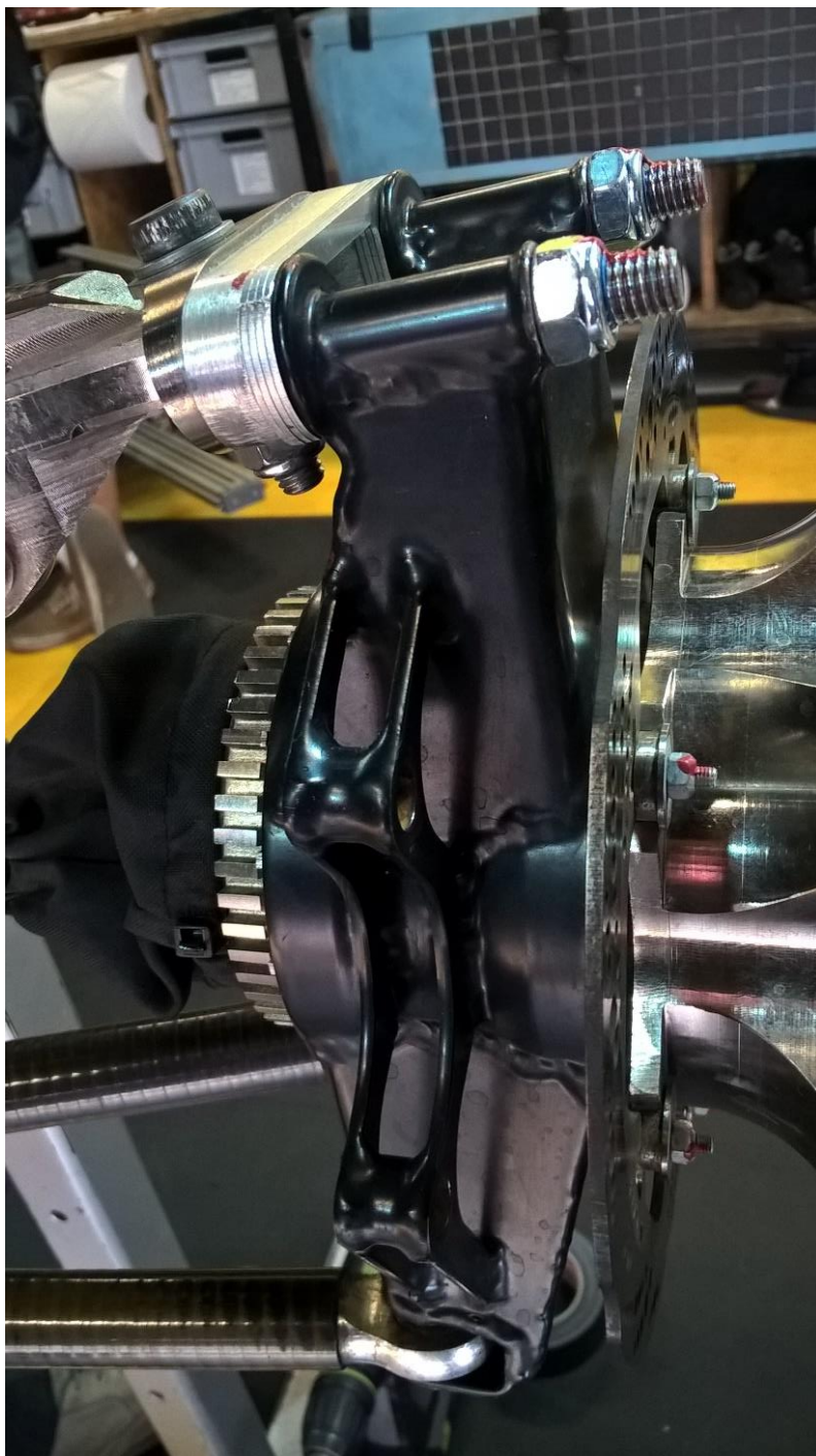
Obrázek 6 Svařovaná těhlice týmu KA Racing [ (5) ]
