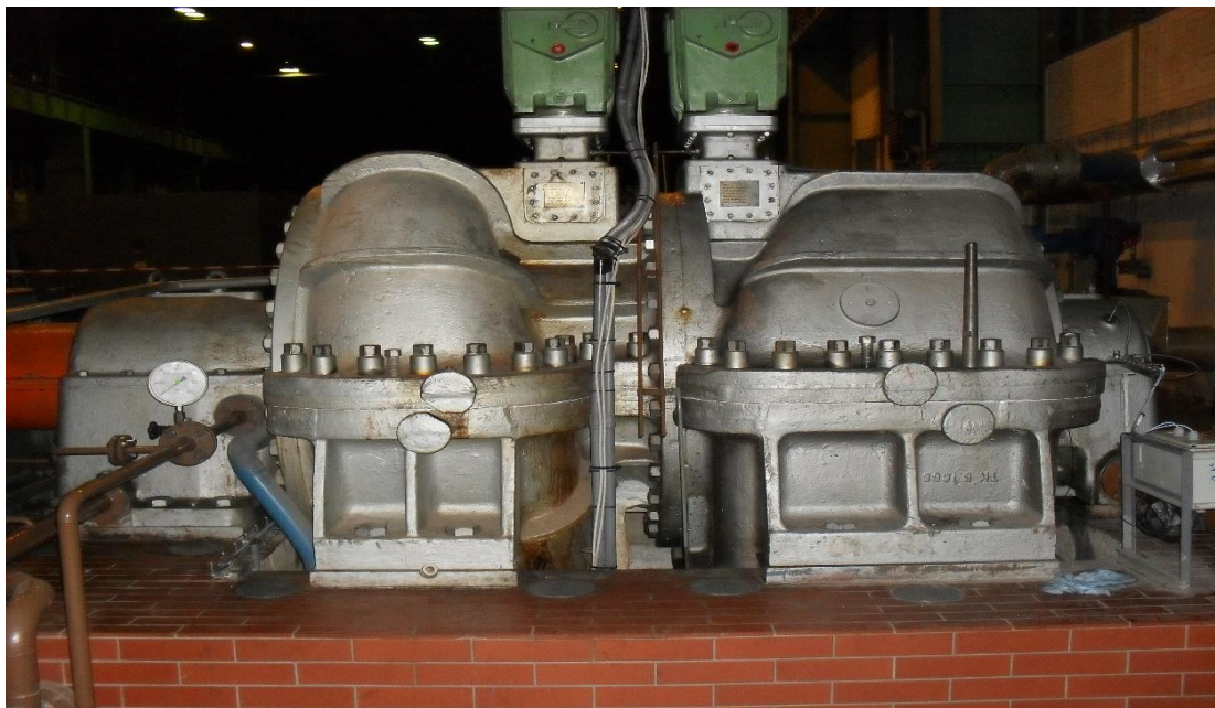
Obr. 4: Axiální turbokompresor ČKD-nízkotlaká část s pohonem lopatek Zdroj: Vlastní
