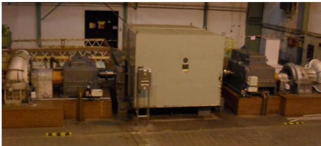
Obr. 5: Axiální turbokompresor ČKD-celkový pohled Zdroj: Vlastní
