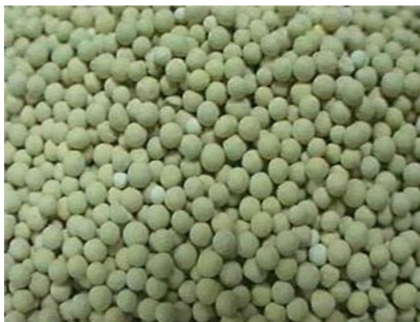
Obr. 12: Ležatá nádoba-TSA molekulové síť Zdroj: Vlastní
