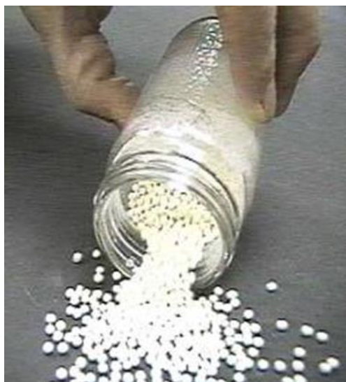
Obr. 9-10: Ukázka adsorbentu-kuliček aluminu a molekulárního síť Zdroj: Prezentace firmy Air Products spol. s r.o.
