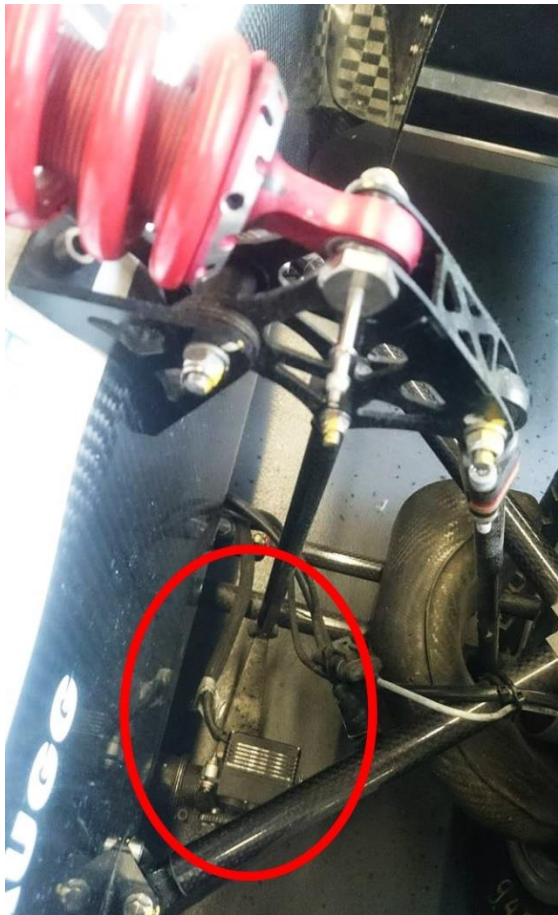
Obr. 14 - Ukázka realizace elektronicky nastavitelných zkrutných stabilizátorů - Rennteam Uni Stuttgart - F0711-9
