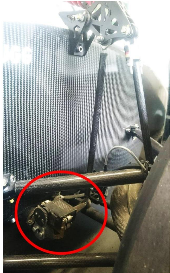
Obr. 14 - Ukázka realizace elektronicky nastavitelných zkrutných stabilizátorů - Rennteam Uni Stuttgart - F0711-9
