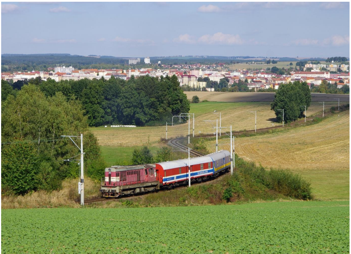
Obrázek 6: Služební vlak SŽDC pro měření radiových sítí s lokomotivou ČD Cargo řady 742 v obloucích před Horkami u Tábora, v pozadí přímý úsek s rychlostí 60 km/h
