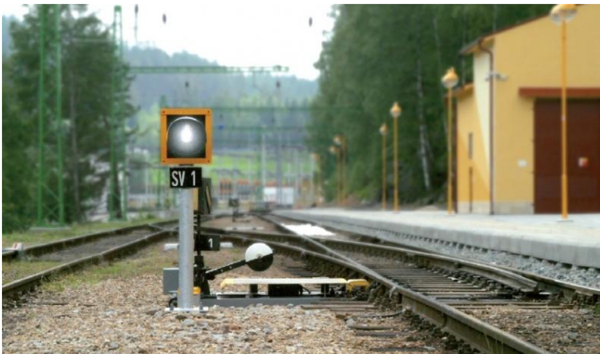
Obrázek 18: Světelné výhybkové návěstidlo samovratné výhybky [14]
