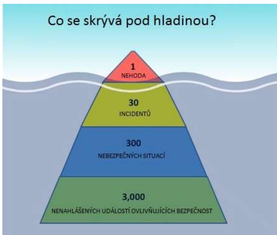
Obrázek 2 Princip SMS - letecké nehodě je možné předejít sledováním provozních událostí.
