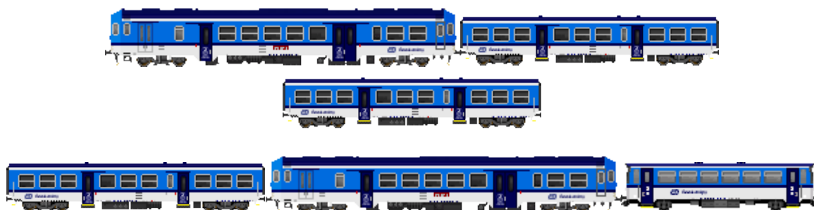
Obr. 26: Příklad nejdelšího řazení vlaku R 1273 o víkendu – 843 + 3 x Btn 753 + 843 + Bdtax 785
