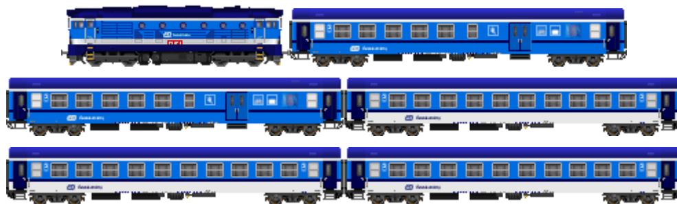
Obr. 19: Příklad nejdelšího řazení vlaku R 1148/1149 v sobotu a 1144/1151 v neděli – 750.7
