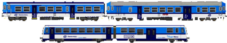
Obr. 31: Příklad nejdelšího řazení vlaku Os 5401 v pracovní dny – Bftn 791 + 843 + 814*
