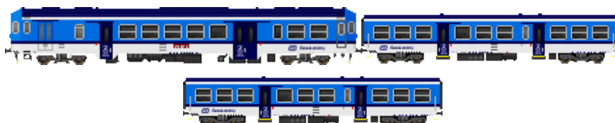
Obr. 25: Příklad řazení vlaku R 1261 v pracovní dny – 843 + 2 x Btn 753
