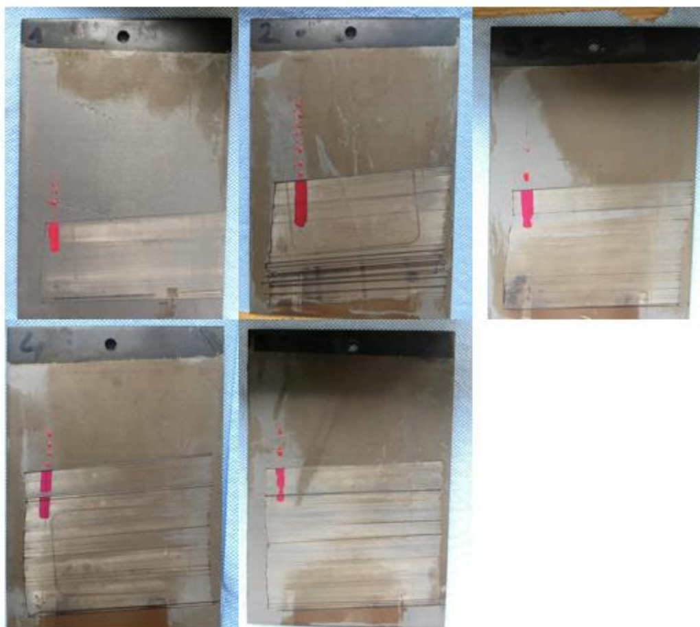
Obrázek 67 Měření zamaštění na vzorcích pomocí inkoustů Everstar
