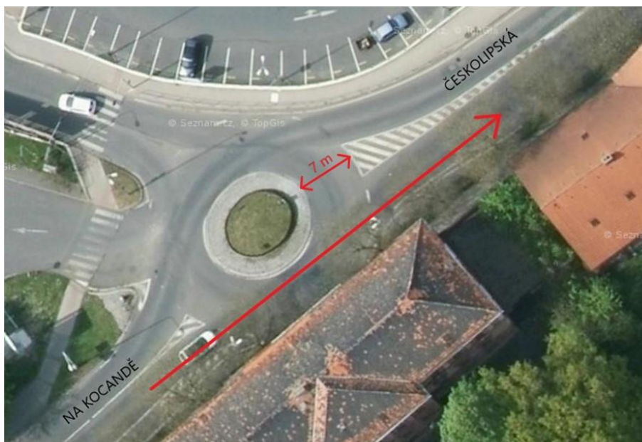
Obrázek 38: Okružní křižovatka Na Kocandě x Českolipská s vyznačením možnosti tangenciálního průjezdu rameny Na Kocandě a Českolipská (Zdroj podkladové mapy: [27])
