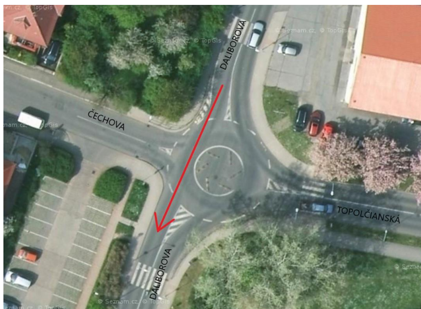
Obrázek 26: Okružní křižovatka Daliborova x Čechova x Topolčianská s vyznačením možnosti tangenciálního průjezdu rameny Daliborova (Zdroj podkladové mapy: [21])
