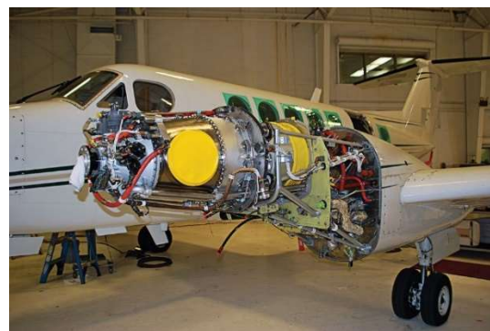
Obr. 11- Uložení motoru PT6 v letounu Beechcraft KingAir B200 [15]
