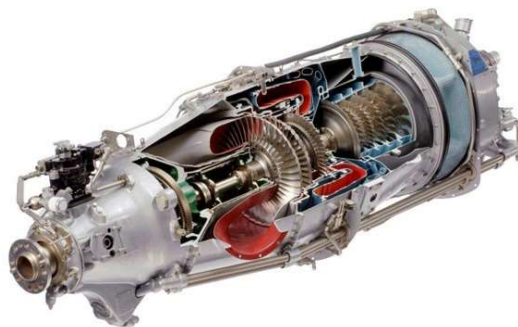
Obr. 10- Motor PT6A-60A v řezu [14]
