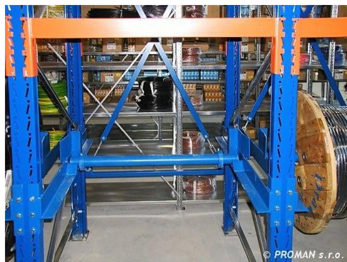
Obr. 8.: Úprava pro uskladňování kabelových bubnů [9]
