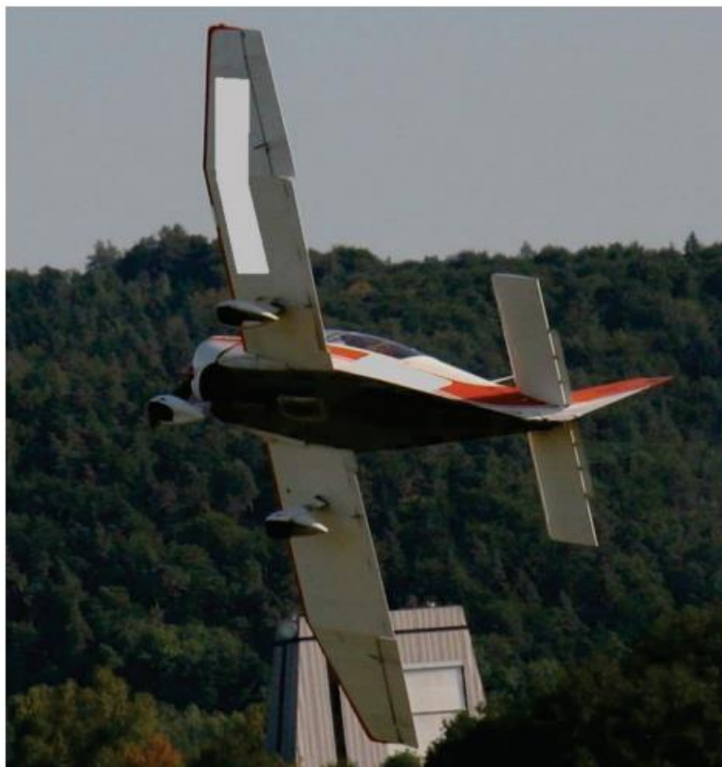
Obrázek 15 DR 400 těsně před střetem se zemí s plně vychýleným křídélky pro vyrovnání náklonu [21]
