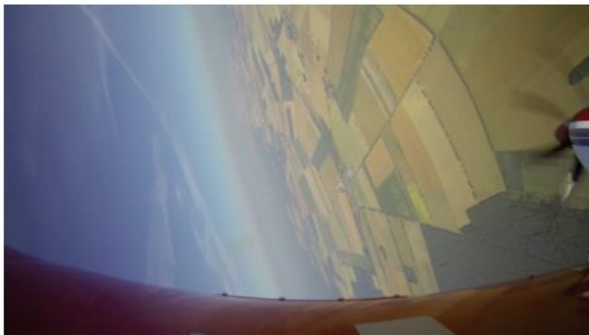
Obrázek 24 Pohled z křídla DR 400 na maximální úhel náklonu ( 110^\circ ) při vlétnutí do úplavu za An-2 [21]
