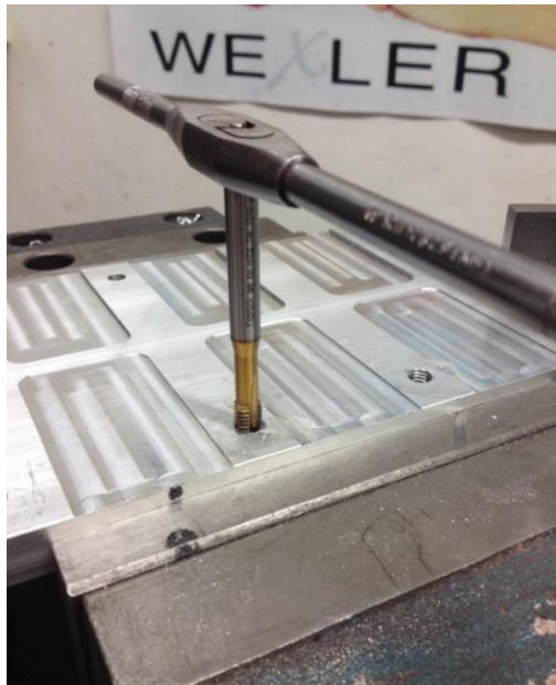
Obrázek 17 Řezání závitu M8 do přípravku
