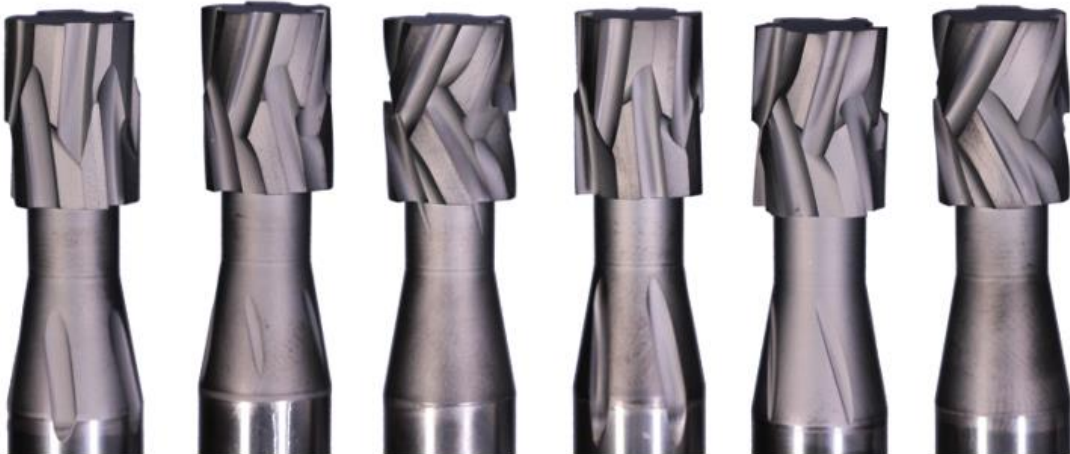
Obrázek 22 Speciální nástroje s různým řezným úhlem
