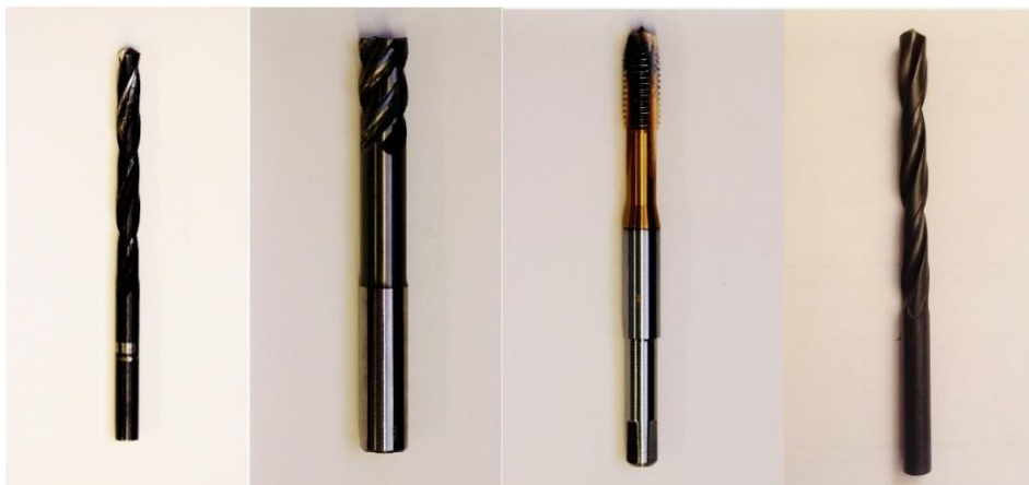
Obrázek 16 Nástroje použité při výrobě přípravku vrták HSS Ø6,8 mm, stopková fréza Iscar ECA-H4 Ø12 mm -18/60C12CFR0, strojní závitník Narex M8 6H a vrták HSS Ø9 mm
