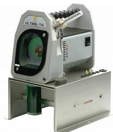
Obr. 13 Speciální brusky s možností nastavení vrcholového úhlu elektrody [19]
