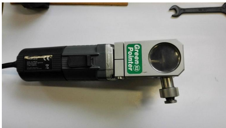
Obr. 13 Speciální brusky s možností nastavení vrcholového úhlu elektrody [19]
