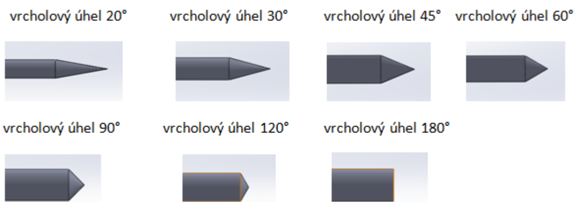
Obr. 17 Elektrody běžné geometrie s rozdílnými vrcholovými úhly
