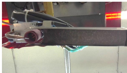
Obrázek 16: Vlečná ochrana s přívodem příd. drátu a drátěnkou
