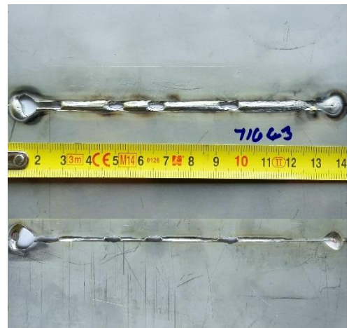
Obrázek 26: TIG 43 - nevyhovující vzorek, v_{sv} = 330 \text{ cm/min}
