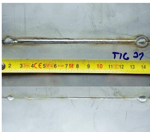
Obrázek 25:TIG 31 - vyhovující vzorek, v_{sv} = 230 \text{ cm/min}
