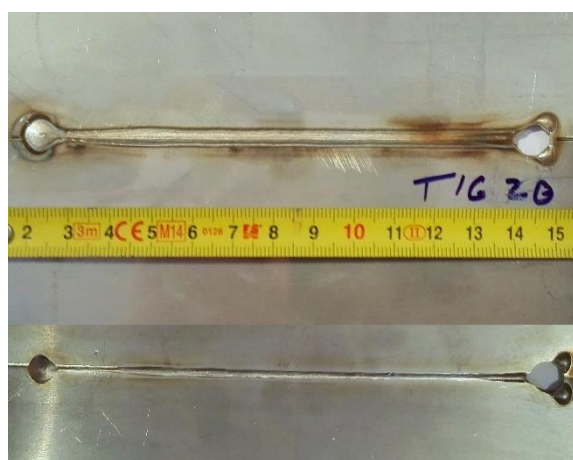
Obrázek 23: TIG 20 - vyhovující vzorek, v_{sv} = 330 \text{ cm/min}
