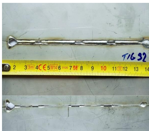
Obrázek 24:TIG 32 - nevhovující vzorek, v_{sv} = 270 \text{ cm/min}
