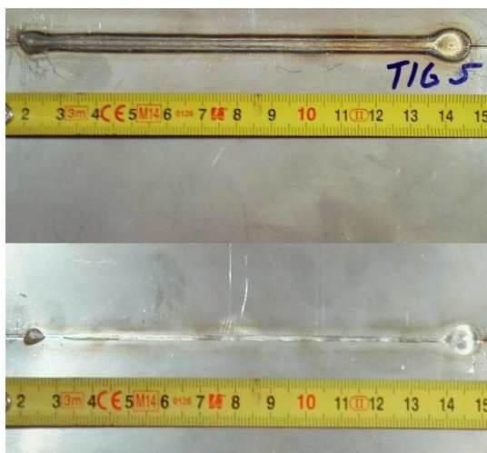
Obrázek 21: TIG 5 - vyhovující vzorec, v_{sv} = 200 cm/min
