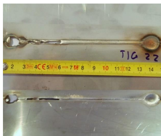
Obrázek 22: TIG 22 - nevhovující vzorek, v_{sv} = 400 \text{ cm/min}
