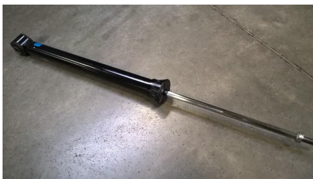
Obrázek 7: Tlumič auta Nissan Micra [13]
