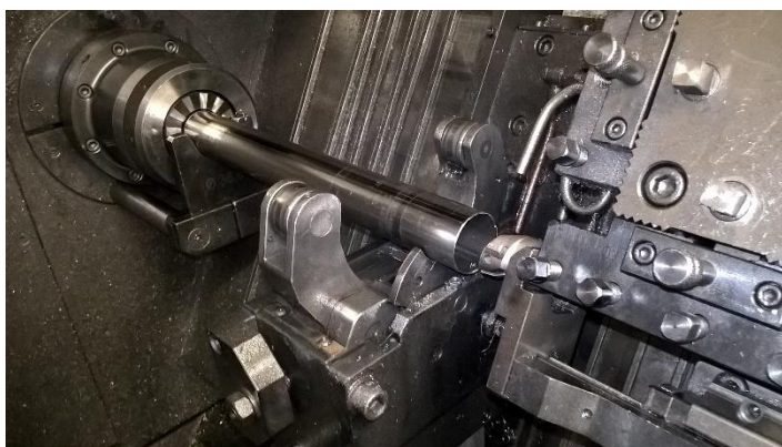
Obrázek 8: Proces obrábění drážky [13]
