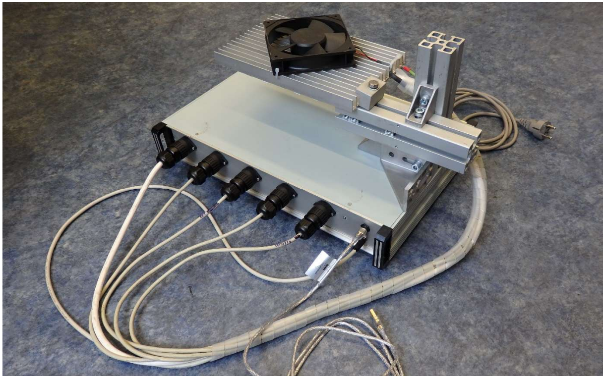
Obr. 1 — Solární simulátor tvořený v dolní části elektrickým zdrojem a v horní části zdrojem záření tvořeným skupinami LED nainstalovanými na hliníkový chladič s ventilátorem.
