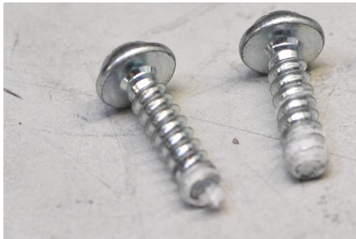
Obr. 43. Ukázka nataveného materiálu vlivem malého průměru otvoru
