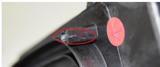
Obr. 12. Ukázka podélného prasknutí domku [24]
