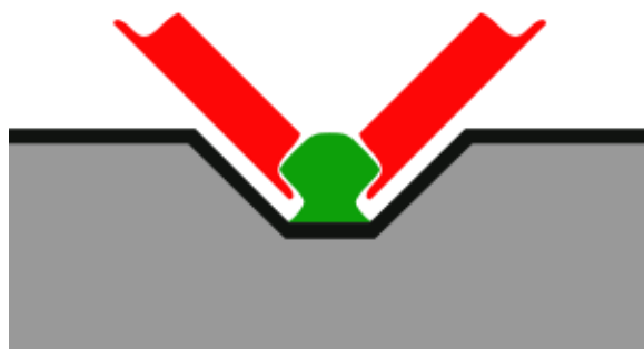
Obrázek 68: Schéma přichycení ke kolejnici, Translohr [80]
