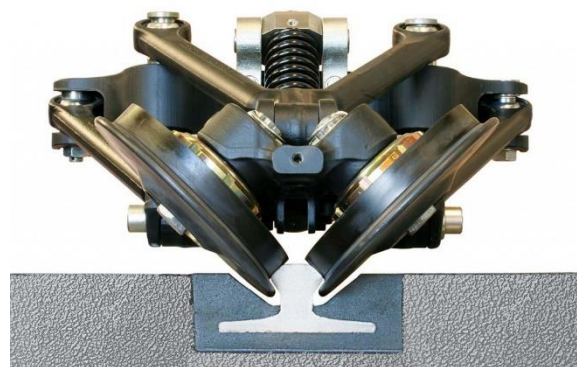
Obrázek 69: Detail vodícího systému, Translohr [81]
