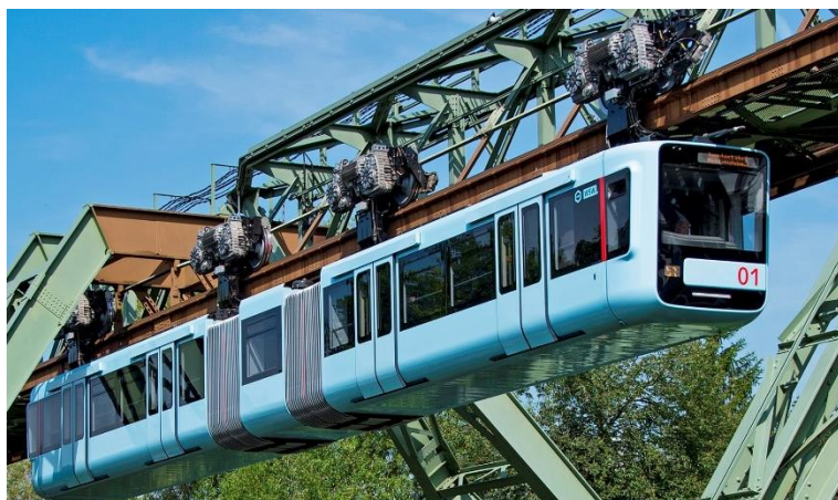
Obrázek 48: Zavěšení vozidla ve Wuppertalu [69]
