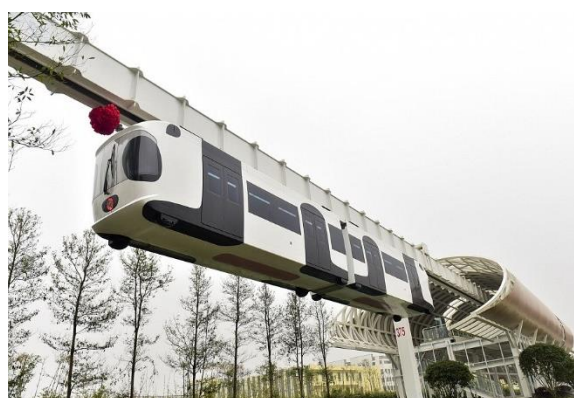
Obrázek 59: Akumulátorová visutá dráha, Čína [77]
