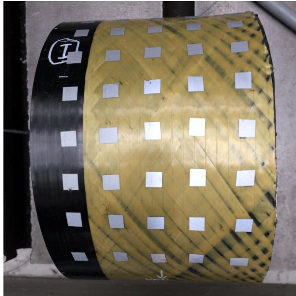
Obr. 7 Pole 25 bodů s reflexními samolepkami. (Na obrázku je bodů 35, hodní dvě řady se ale při měření nepoužívaly)
