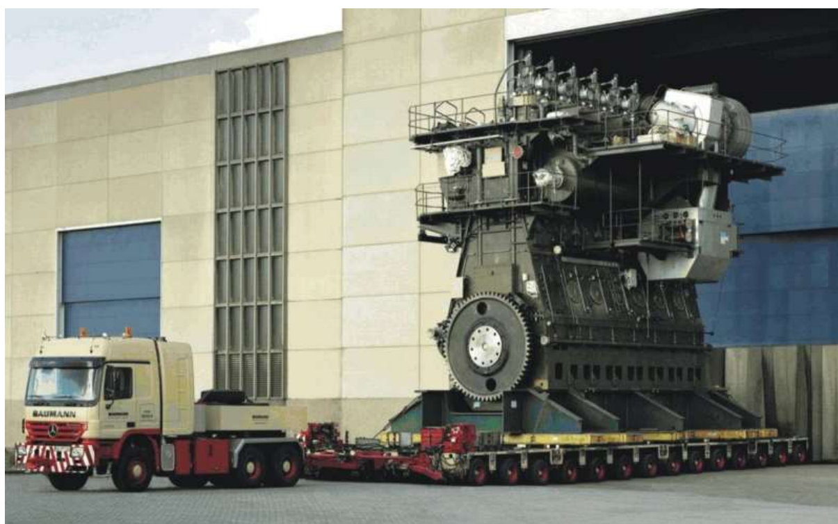
Obrázek 6: Největší dvoudobý motor na světě společnosti Wärtsilä navržený pro kontejnerové zaoceánské lodě [7]
