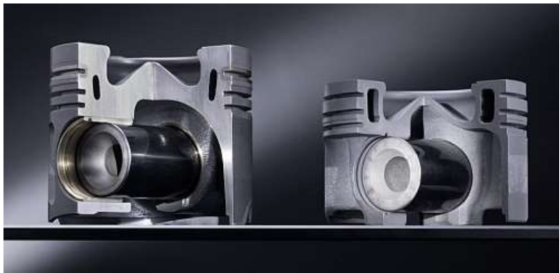
Obrázek 19: Písty značky Mercedes-Benz, hliníkový píst (vlevo), ocelový (vpravo) [15]
