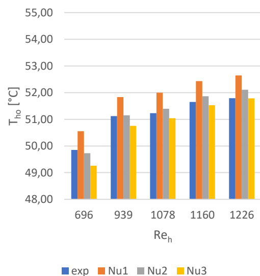
OBR. 22: TEPLOTA OCHLAZOVANÉ TEKUTINY NA VÝSTUPU Z VÝMĚNÍKU PRO EXPERIMENTY C5_H1 AŽ C5_H5 ( Re_c=885\div 904 )
