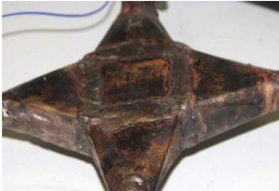
OBR. 13: ANALYZOVANÝ VÝMĚNÍK S PŘIVAŘENÝM POTRUBÍM [8]
