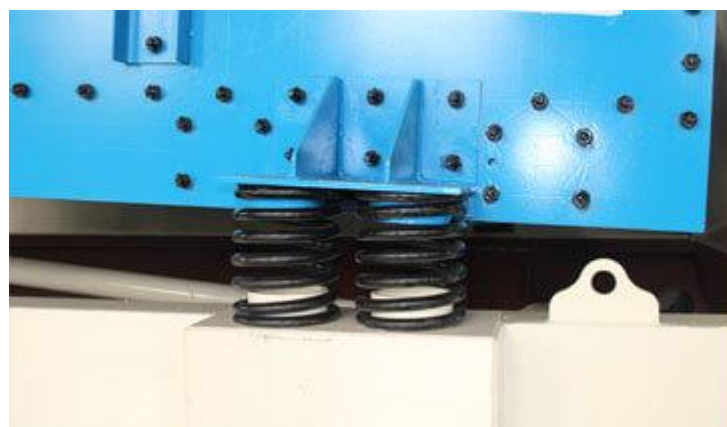
Obr. 7.: Uložení vibračního soustrojí na pružinách
