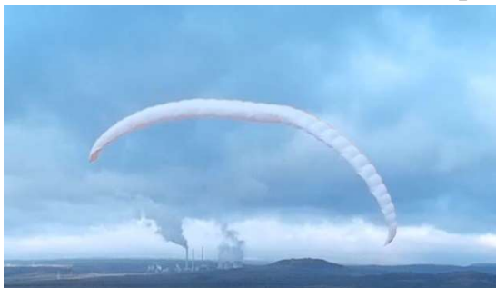
Obrázek 5.1.1 Deformace vrchlíku v důsledku rozdílné výšky závěsů.
