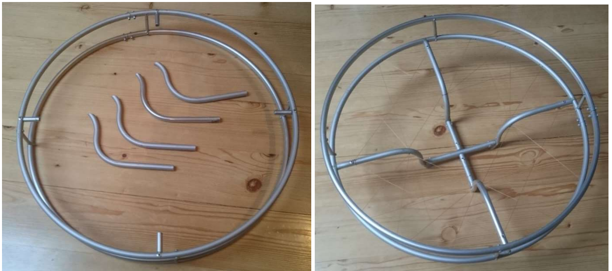
Obrázek 3.4.4.1. Spojené kruhy s připravenými spojkami, Obrázek 3.4.4.2. Smontovaná klec s výpletem paprsky před montáží.
