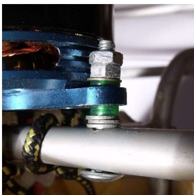
Obrázek 5.3.4. Připevnění motoru pomocí silentbloku a kontramatice.
