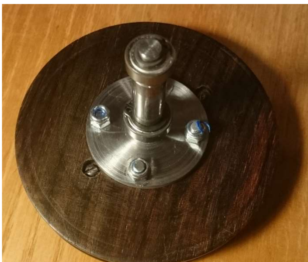
Obrázek 3.3.5.2. kladka s namontovanou osou včetně nalisovaných a zajištěných ložisek
