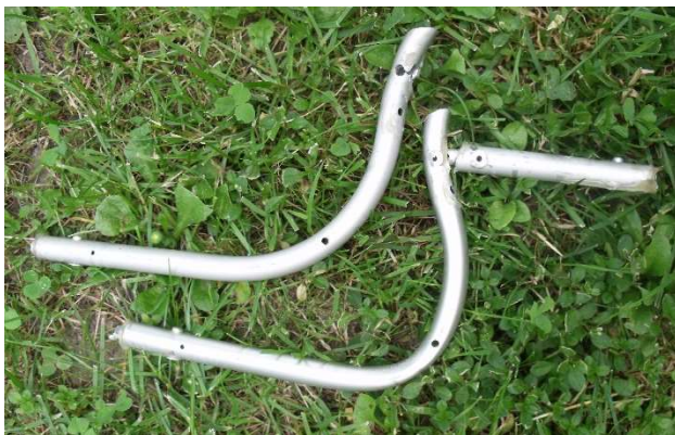
Obrázek 5.3.2. viditelná deformace paprsku (vpravo dole) ve srovnání s nedeformovaným (vlevo nahoře), viditelné porušení spoje.
