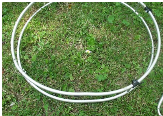
Obrázek 5.3.3..deformace obou vnějších kruhů s částečným porušením materiálu.
