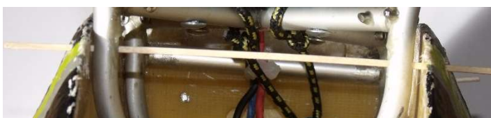
Obrázek 3.4.4.3. Uchycení koše k modelu pomocí 2 kruhových nosníků a opření o L profily.
