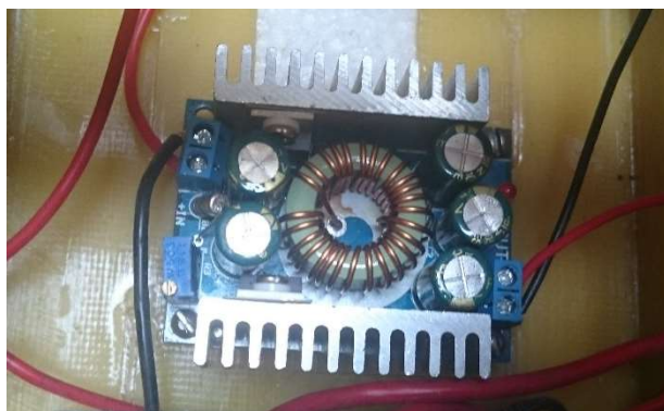
Obrázek 3.2.2.1. Uložení a zapojení DC-DC měniče v modelu.
