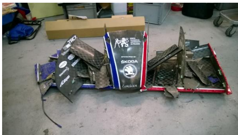
Obr.6 Přední křídlo po nehodě FS.07
