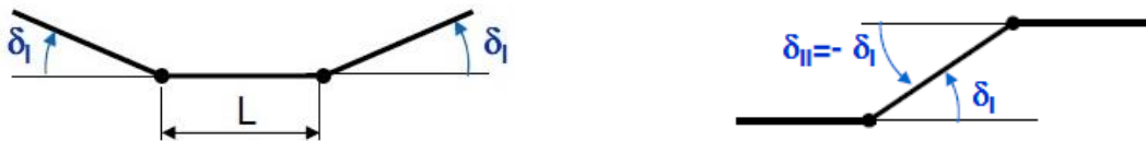
Obrázek 13 - Zapojení kloubového hřídele do „M“ (vlevo) a do „Z“ (vpravo) [12]
